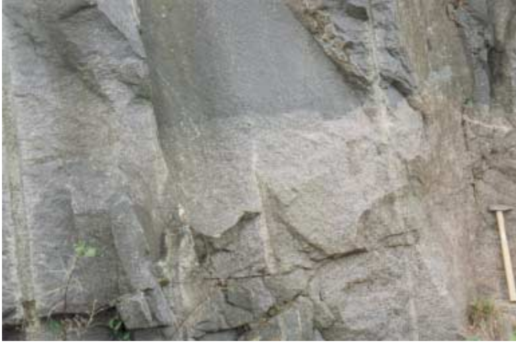
a) Inhomogen blandning av medelkornig kvartsmonzodiorit-granodiorit (rödgrå) och finkornig, dacitisk-andesitisk, vulkanisk bergart (mörkt grå). Vägskärning ca 100 m norr om reaktor 3 på Simpevarpshalvön (RAK 1552285/6366267).
