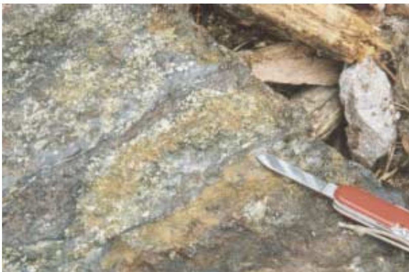
Figur 20. Exempel på spröd deformation och mineralisering i bergtäkten vid avfallsanläggningen Storskogen.
