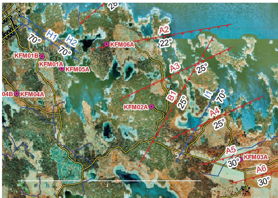
Figur 3-18. Från reflektionsseismiska mätningar tolkade reflektorers skärning med markytan. Dessa reflektorer som sannolikt representerar sprickzoner, har troligen en avgörande betydelse för vattentransporten genom speciellt den sydöstra delen av undersökningsområdet.
