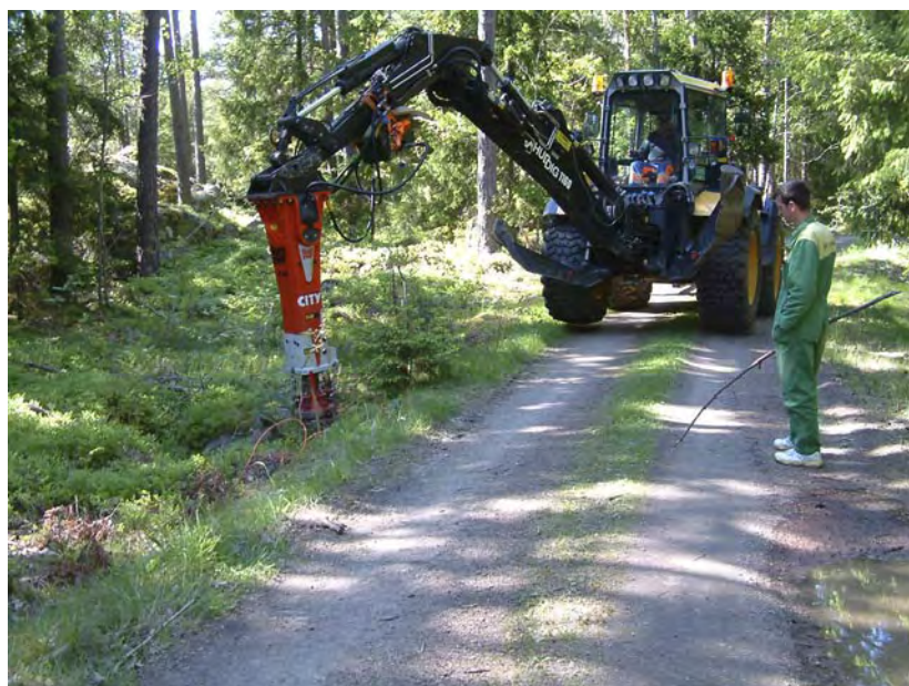
Figur A-10. Seismiska undersökningar med vibrationshammare.
