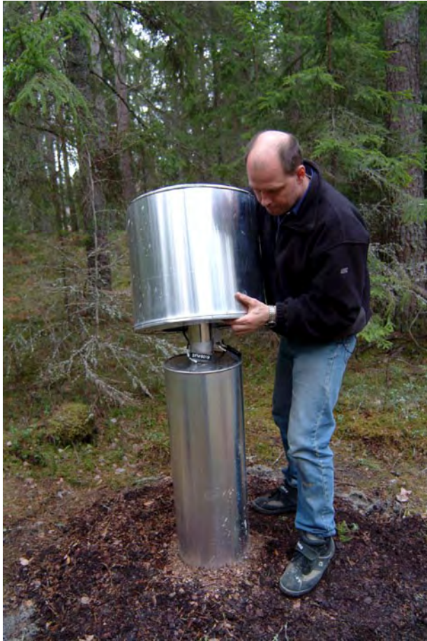
Figur A-2. Förberedelse för mätning av grundvattennivå i jordborrhål.
