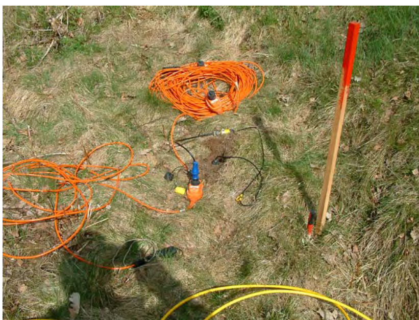
Figur A-11. Förberedelser för borrning och laddning för reflektionssesimik.
