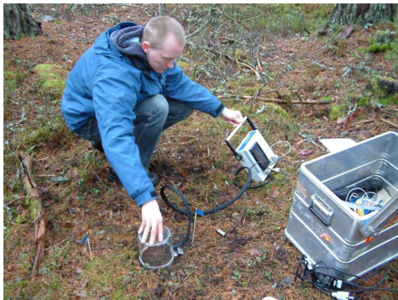
Figur 3-3. Mätning av terrester produktion och respiration.
