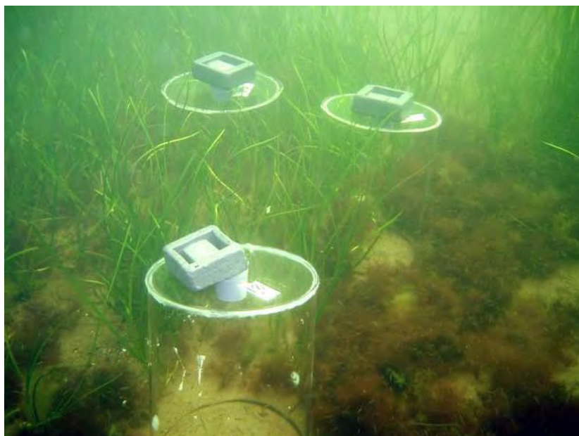
Figur 3-4. Undersökningsuppställning vid produktions- och respirationsuppskattning i vattenmiljöer.
