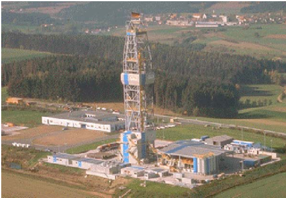
Figur 2-10. Borrrigg – UTB-1 GH 300 EG som användes i det kontinental djupborrningsprogrammet i Tyskland (Harrison 2000).
