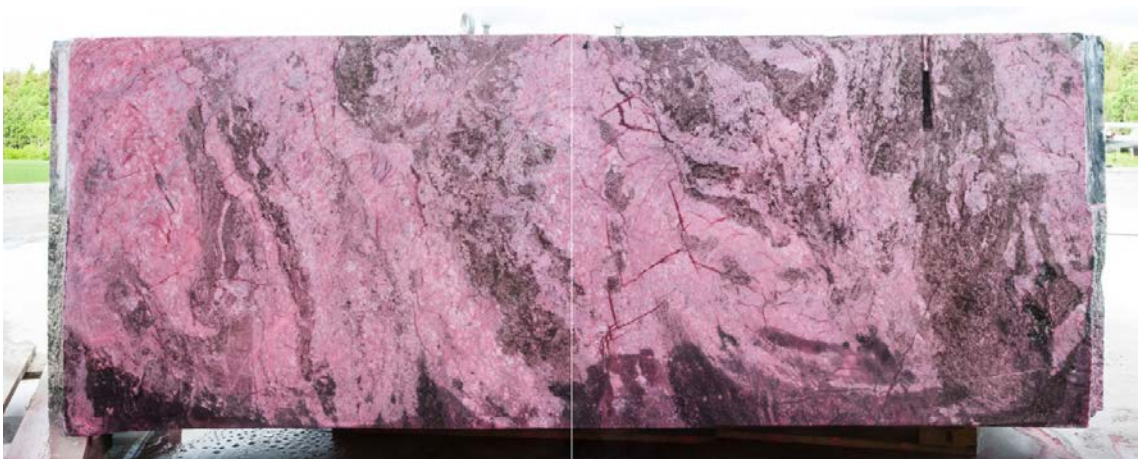
Figur 5-14. Foto av den sågade ytan för bergpluggen med penetrant.
