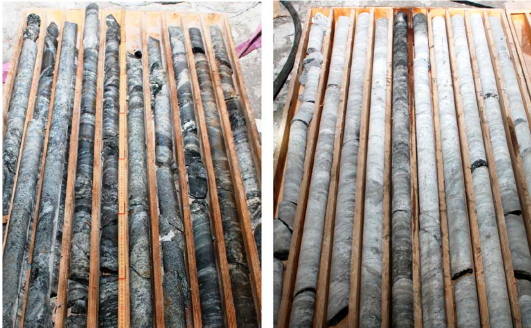
Figur 2-5. Foto av lådor med borrkärnor från det övre vänstra respektive det nedre högra borrhålet enligt figur 2-4.
