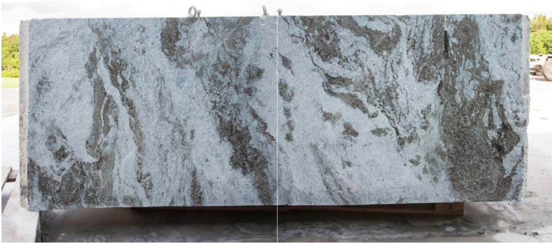
Figur 5-13. Foto av den sågade ytan för bergpluggen. Snittet är vinkelrätt tunnelriktningen.
