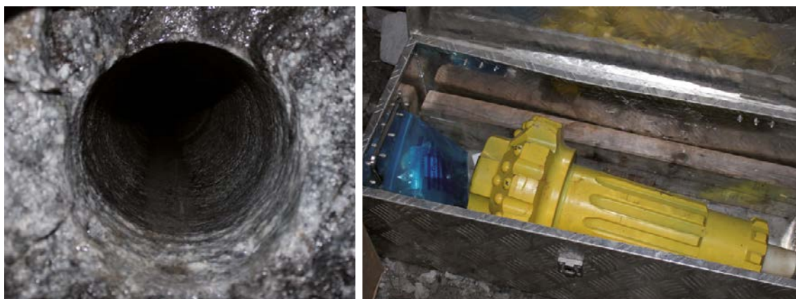
Figur 3-3. Foto av det upprymda hålet och den hammarborrkrona som användes vid sänkborrningen.
