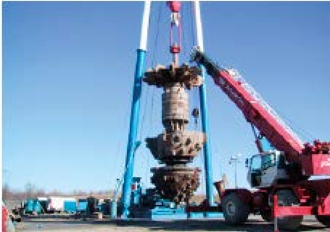
Figur 5-22. Borrkrona för schaktborrning (blind shaft drilling) med diameter 5,5 m till 100 m för ventilation. (Shaft drillers 2007).
