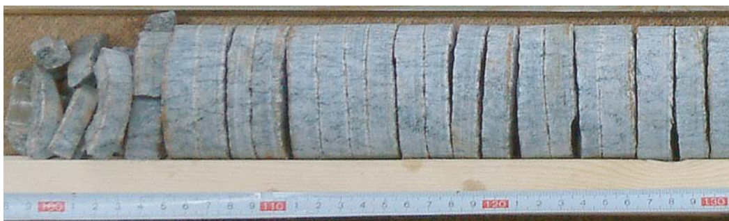
Figur 5-20. ”Core discing”, där borrkärnan skivas upp som i figuren, är ett tecken på höga bergspänningar.
