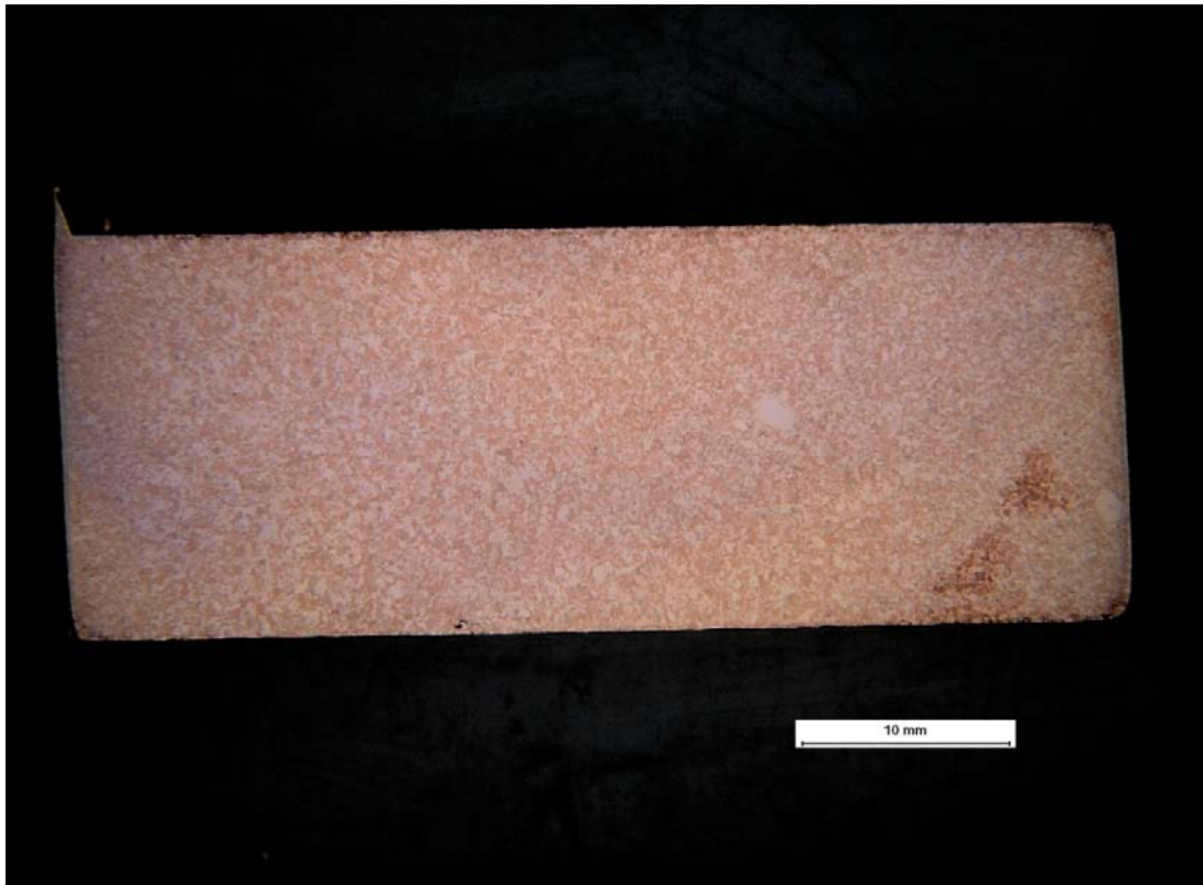
Figur 3-36. Metallografiskt tvärsnitt på kopparprov från kapseln i deponeringshål 6 Id nr-Prov 3, Provbit från mitten av den cylindriska ytan. Jämförelseskalan är 10 mm lång.
