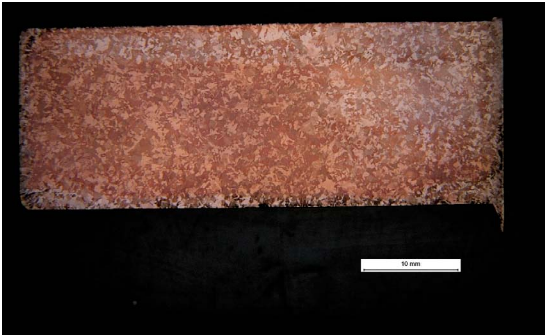
Figur 3-32. Metallografiskt tvärsnitt på kopparprov från kapseln i deponeringshål 6 Id nr-Prov 1, Provbit från locket. Jämförelseskalan är 10 mm lång.
