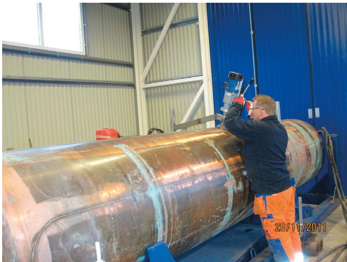
Figur 2-2. Foto från provtagning av kapseln som varit exponerad i Prototyp deponeringshåll 6.
