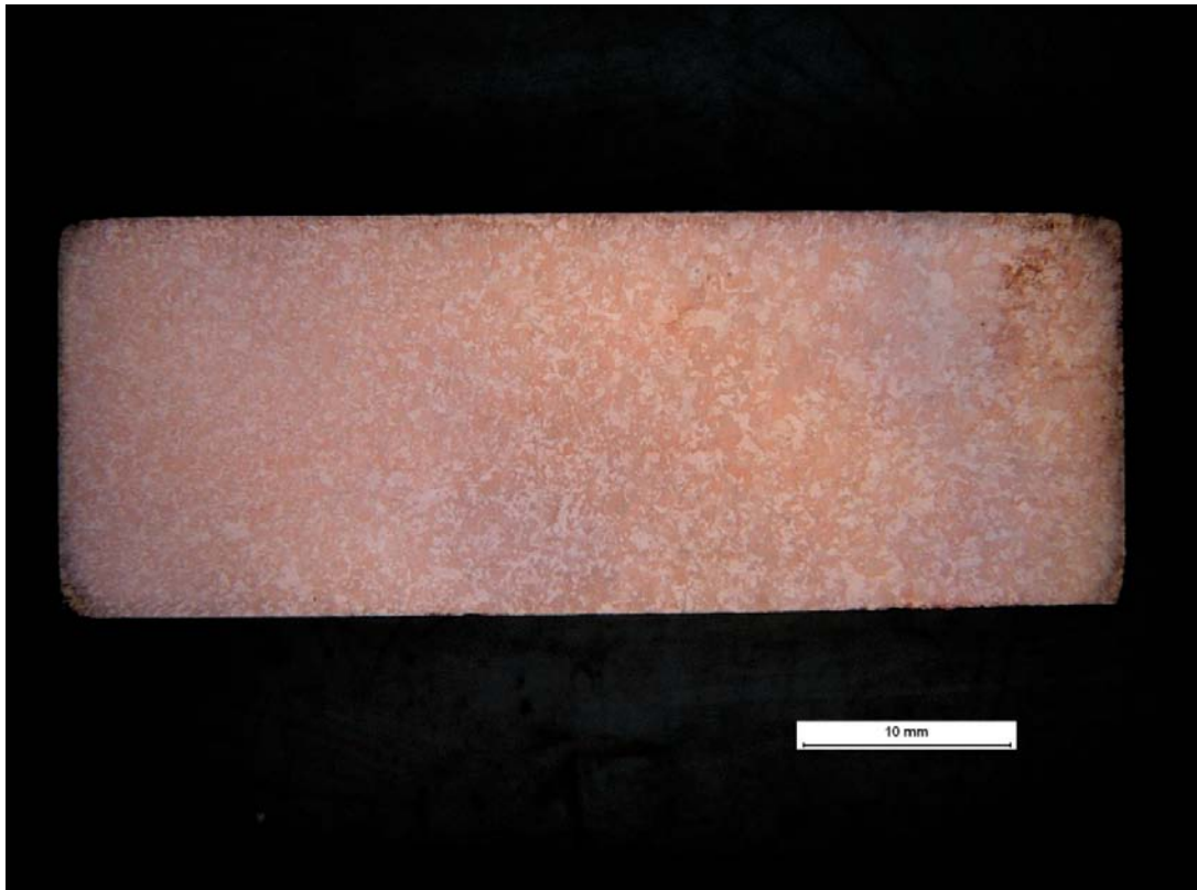
Figur 3-42. Metallografiskt tvärsnitt på kopparprov från kapseln i deponeringshål 6 Id nr-Prov 7, Provbit från bottenplattan. Jämförelseskalan är 10 mm lång.
