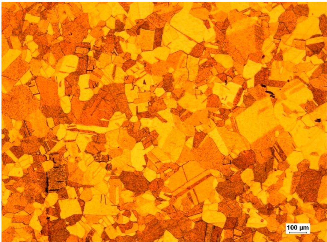
Figur 3-37. Metallografiskt tvärsnitt på kopparprov från kapseln i deponeringshål 6 Id nr-Prov 4, Provbit från cylindern långt ned. Jämförelseskalan är 0,1 mm lång.
