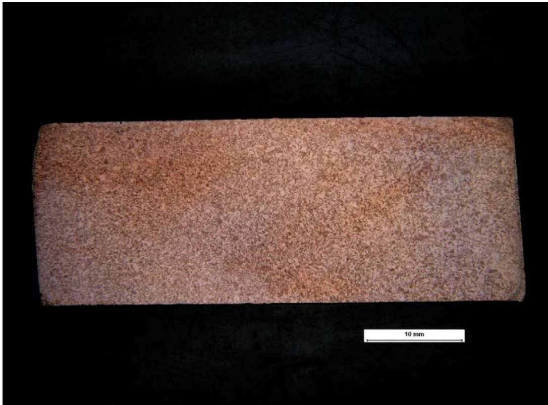
Figur 3-38. Metallografiskt tvärsnitt på kopparprov från kapseln i deponeringshål 6 Id nr-Prov 4, Provbit från cylindern långt ned. Jämförelseskalan är 10 mm lång.
