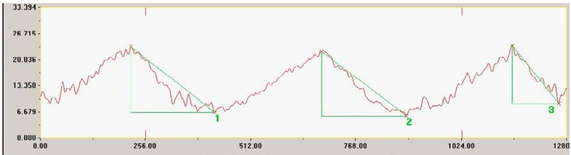
Figur 3-2. Ytprofil från konfokalmikroskopi av prov från ringen på kapseln i deponeringshål 5. Förstoring 10x. Måttkala i mikrometer.
