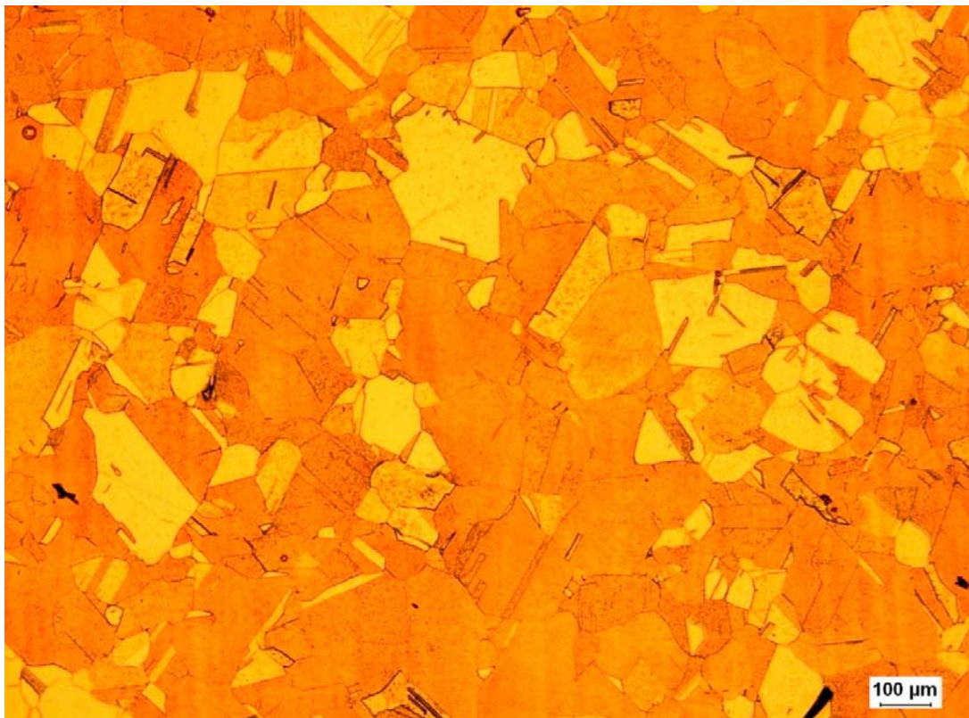
Figur 3-39. Metallografiskt tvärsnitt på kopparprov från kapseln i deponeringshål 6 Id nr-Prov 5, Provbit från cylinderns svetsade del. Jämförelseskalan är 0,1 mm lång.
