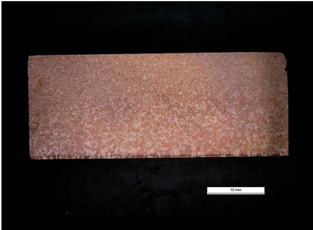
Figur 3-40. Metallografiskt tvärsnitt på kopparprov från kapseln i deponeringshål 6 Id nr-Prov 5, Provbit från cylinderns svetsade del. Jämförelseskalan är 10 mm lång.
