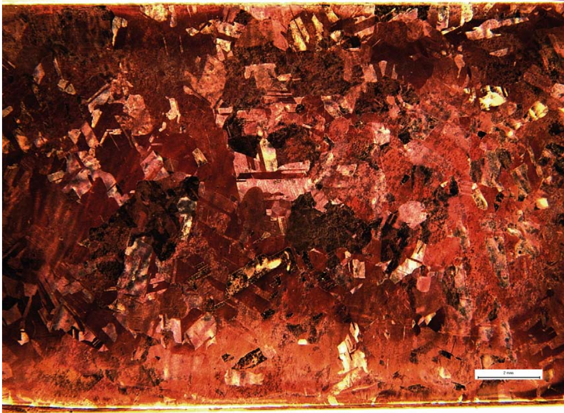
Figur 3-26. Metallografiskt tvärsnitt på kopparprov från ringen på kapseln i deponeringshål 5. Jämförelseskalan är 2 mm lång.
