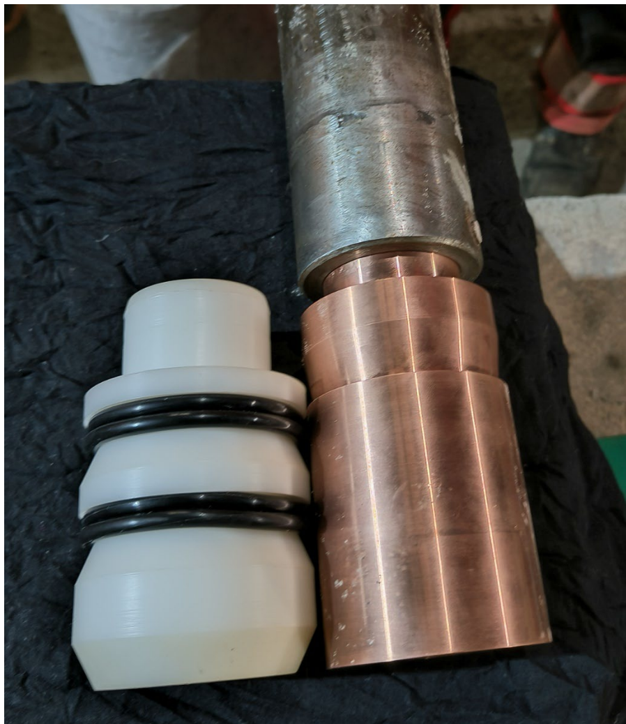
Figur 3-5. Monteringsrör för kopparexpander och tätningselement.
