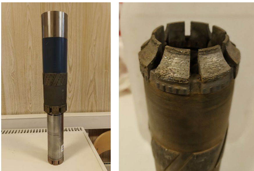
Figur 4-7. T.v.: Rymningsverkyget har en pilot försedd med en 56 mm borrhkrona medan rymningsborrkronan är en standard borrhkrona i N-dimension (75,8 mm). T.h.: Borrhkronan slits i den yttre delen vid upprymningen.
