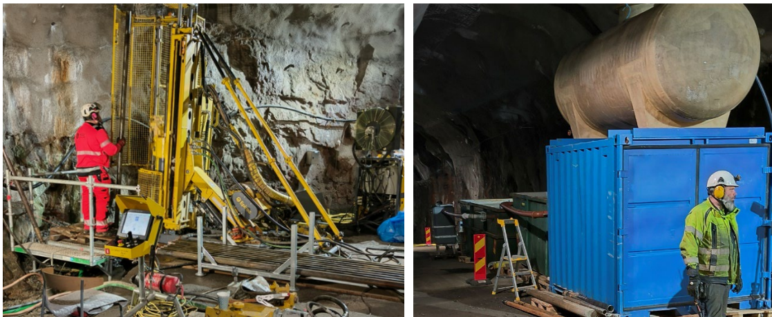
Figur 3-1. T.v.: Bormaskin Diamec Smart 6 med styrpulpeten i förgrunden. T.h.: Mätcontainern med spolvattentank ovanpå taket. I bakgrunden syns två sedimentationscontainrar.
