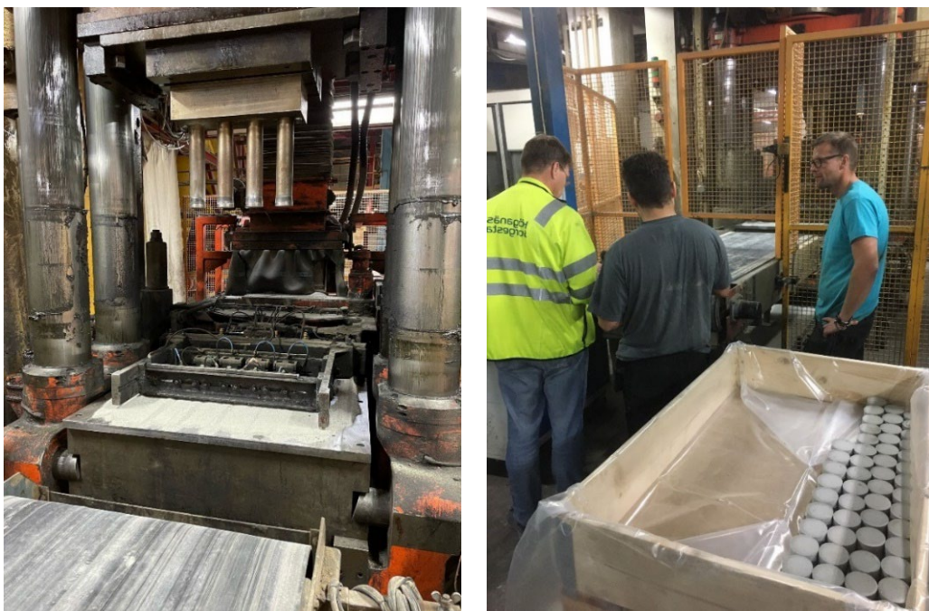
Figur 4-10. T.v.: Foto som visar pressen som använts vid tillverkningen (SACMI 1000 ton). Fyra bentonitpuckar pressas i varje presscykel. T.h.: Bentonitpuckarna staplas i pallar och försluts med plast (foto från tillverkning 2021).
