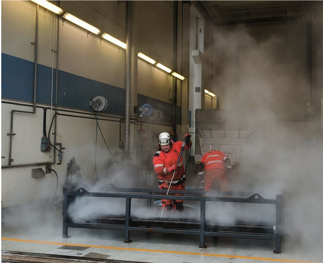
Figur 4-4. Alla nya borrör är rostskyddade varför det är viktigt att avfetta och hetvattenvätta rören innan de ska användas i borrhålet.
