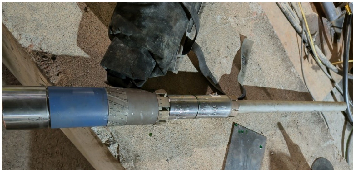
Figur 3-3. Pilotborrkrona för upprymning av KFR02 från 56 mm till 75,8 mm diameter.
