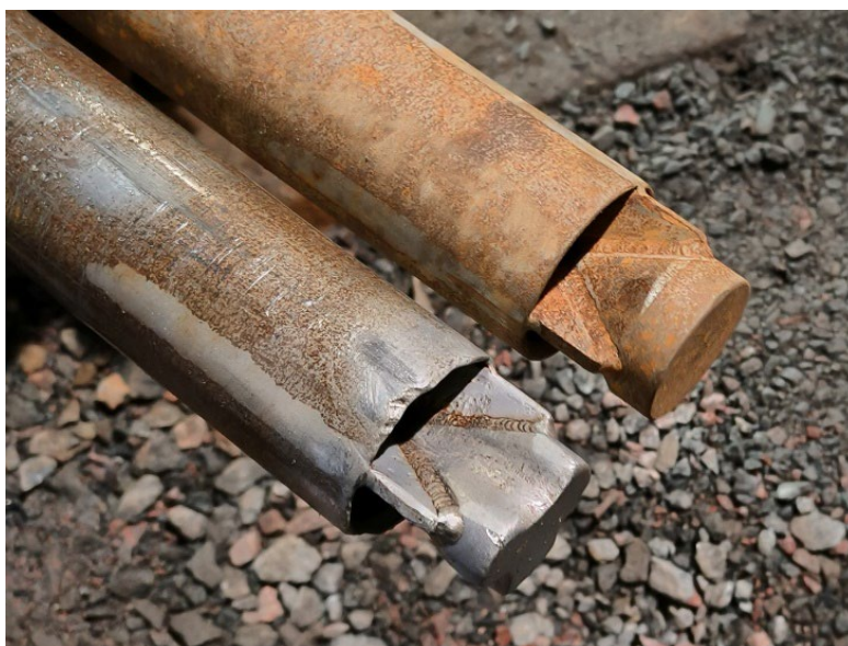
Figur 3-4. Monteringsrör för sandinstallationen.
