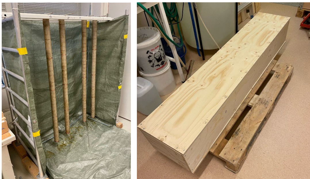
Figur 4-11. T.v.: Lackning av färdigmonterade bentonitpaket. T.h.: Inplastade och förpackade bentonitpaket till KFR02.
