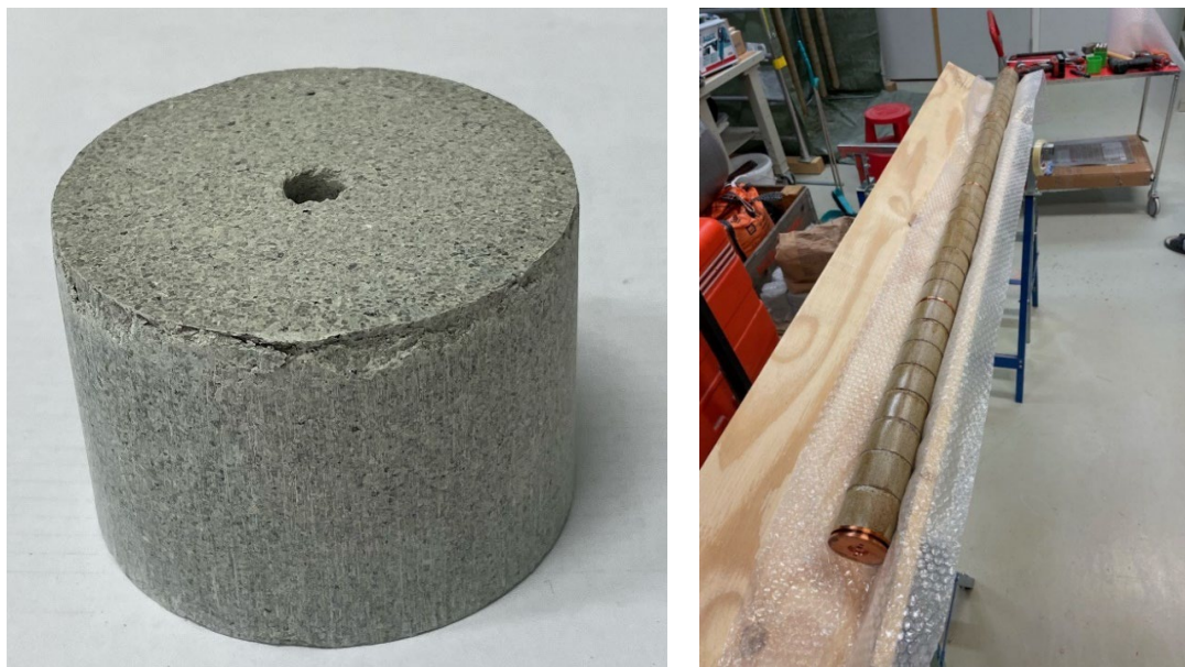
Figur 4-9. T.v.: foto på en bentonitpuck med borrar centrumhål. T.h.: foto på ett lackat bentonitpaket. Bentonitpaketet utgörs av 32 stycken bentonitpuckar, trädda på en kopparstång.
