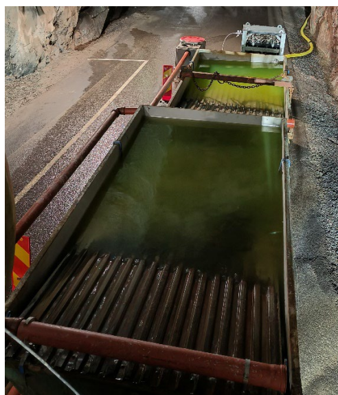
Figur 3-5 Sedimentationsanläggningen nedanför bormaskinen. Huvuddelen av borkaxet sedimenterar i den första containern. Vid låga inflöden i början av borrhningen består huvuddelen av returvattnet av spolvatten som är färgat grönt av spårämnet uranin.
