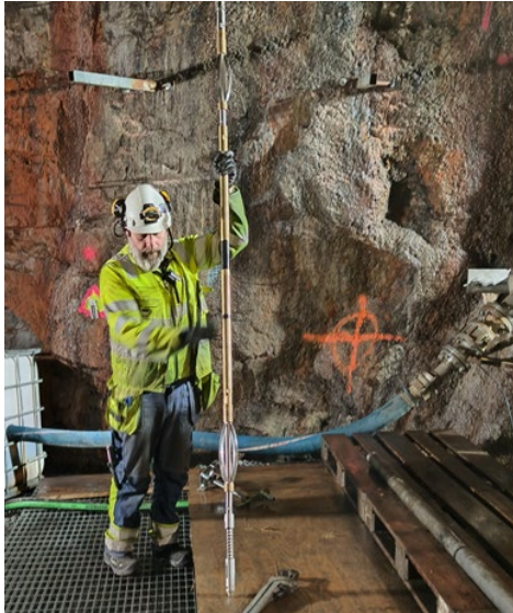
Figur 4-6 T.v.: Reflexgyrot förberett för att stoppas in i borrhöret. T.h.: Devigyrot som används vid styrningen och för kontrollmätning efter styrning.
