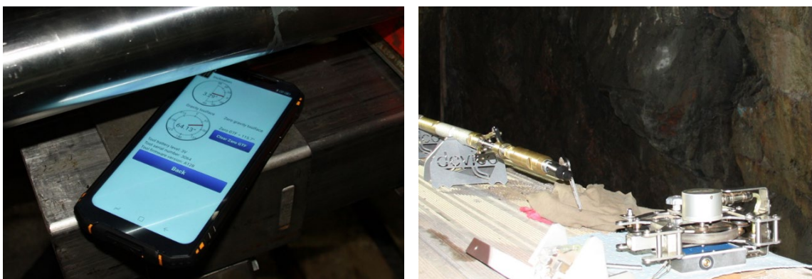
Figur 3-8 T.v.: I DeviDrill- kärnröret finns ett enklare gyro som mäter tool-face och lutning. Detta används för att orientera DeviDrill- kärnröret. T.h.: Devico gyro pumpas in i borrhören, och ger med det digitala räkneverk längdmåttet som används för att mäta resultatet av den gjorda styrningen.
