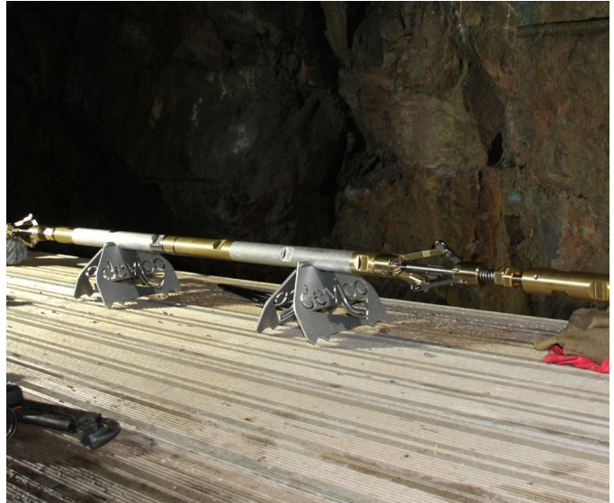
Figur 4-6 T.v.: Reflexgyrot förberett för att stoppas in i borrhöret. T.h.: Devigyrot som används vid styrningen och för kontrollmätning efter styrning.
