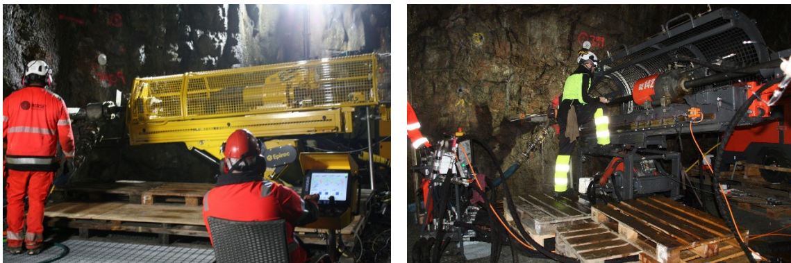
Figur 3-1 T.v. KFR90 borrades med Diamec Smart 6, som är en digitalt styrd bormaskin, medan KFR91 (t.h.) borrades med en Sandvik DE142, vilken är en manuellt styrd bormaskin.
