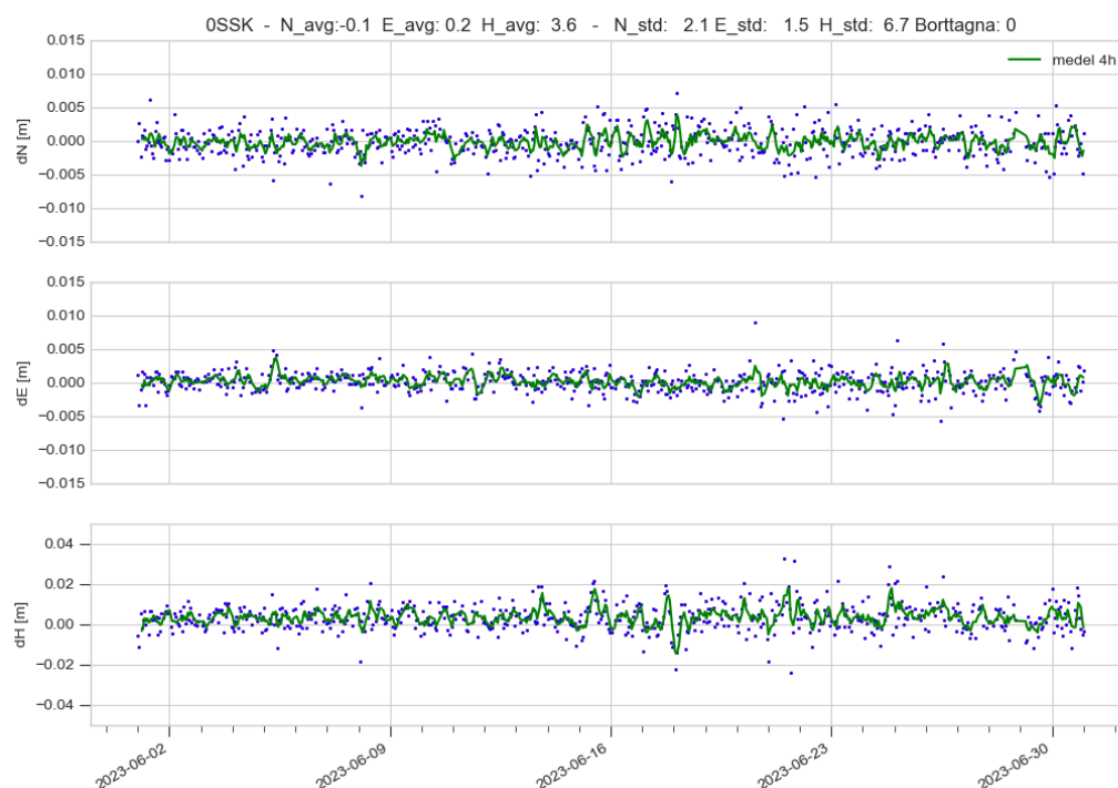
Figur 6-22. Koordinattidsserie för SSKA.0 från NRT-beräkning av Swepos-nätet, juni 2023. Varje blå prick motsvarar koordinaten från beräkningen av en timmes GNSS-observationer. De gröna linjerna visar glidande medelvärden för de senaste fyra timmarna.
