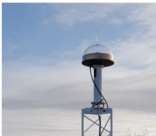
Figur 6-27. Den s.k. radomen – skyddshuven på antennen – har en pigg på toppen, som ska göra att måsar och andra fåglar inte ska vilja sitta på radomen och därmed skymma antennerna.
