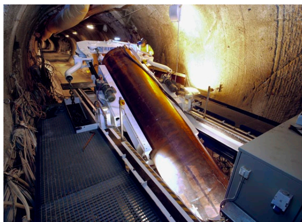
Ett av de viktigaste fullskaleförsöken är Prototypförvaret där sex fullstora kapslar har deponerats i berget.
