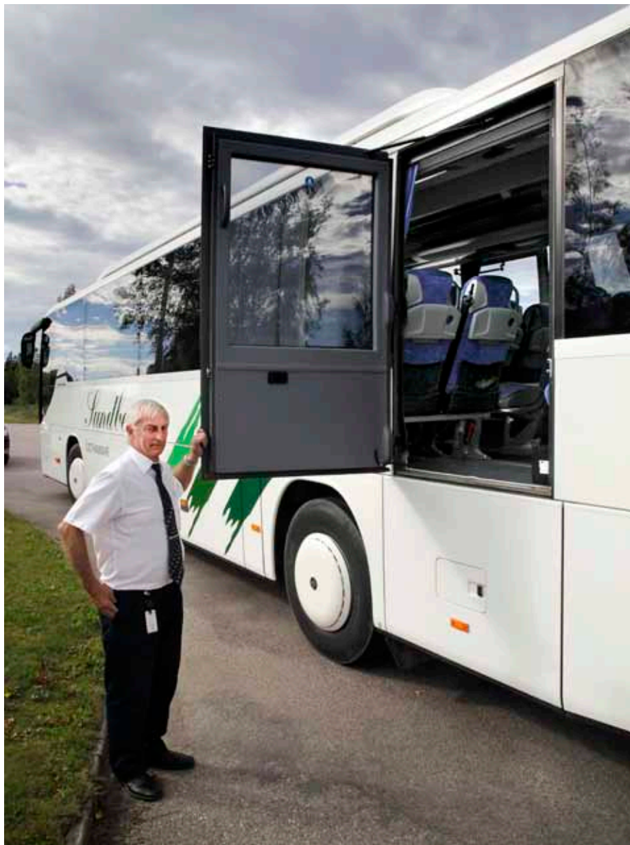
Säkerheten främst. Åke Sundberg visar den speciella nödutgången som finns på "SKB-bussen", en av många säkerhetsdetaljer på fordonet som tar besökare under jord.
