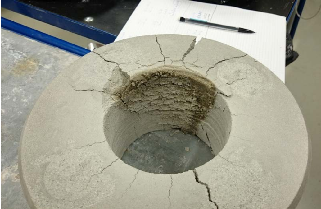
Figur 10-9. Exempel på ett block med en begynnande kondensationszon och de sprickor som denna har orsakat.
