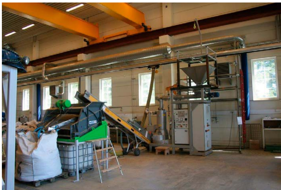
Figur 10-17. Pelletspress vid Äspölaboratoriet.
