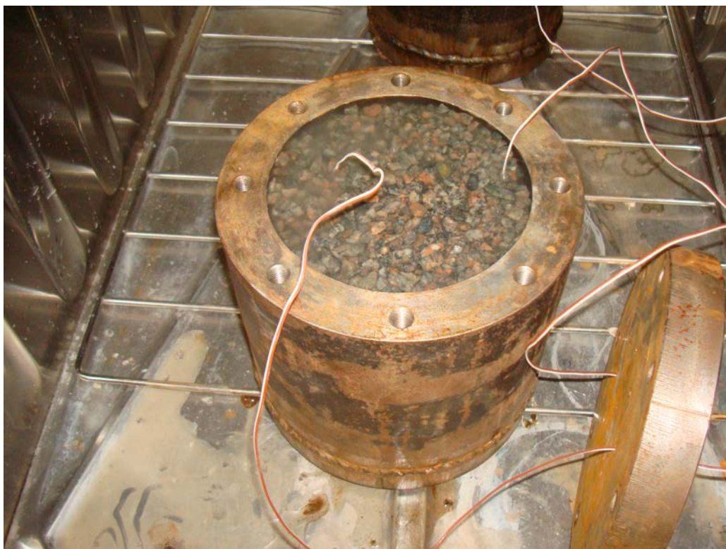
Figur 9-4. Experimentuppställning använd av Pålbrink och Rydman (2013). Den kraftiga stålbehållaren innesluter en vattenmättad grusbädd i vilken en betongcylinder har placerats. Stålcylindern motsvarar här urberget medan grusbädd och betongcylinder motsvarar återfyllnadsmaterial samt betongkonstruktion i IBMA. Notera cylinderlocket med genomföringar för sladdar från temperaturgivare monterade på provet.
