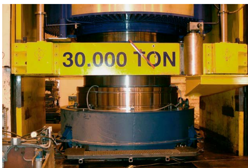
Figur 10-16. Enaxlig press för tillverkning av buffertblock.
