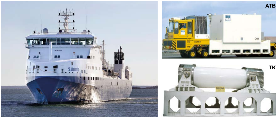
Figur 2-9. M/s Sigrid samt transportbehållare för kortlivat radioaktivt avfall (ATB) och för hårdkomponenter (TK).
