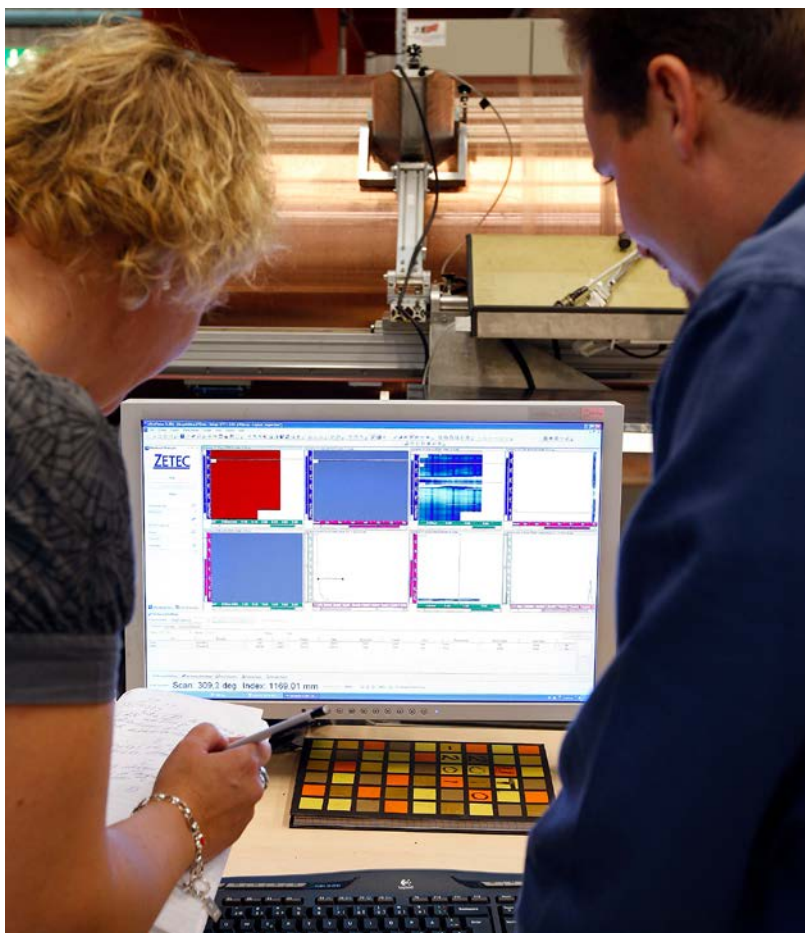
Figur 8-4. Ultraljudsteknik är en av flera tekniker för oförstörande provning.
