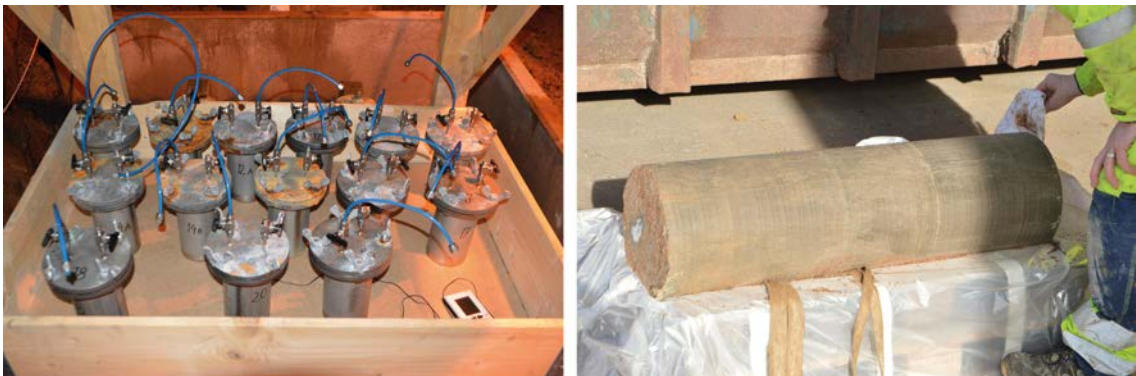
Figur 9-1. Stålbehållare innehållande materialprover, grundvatten från Äspölaboratoriet och krossad cement (vänster bild) samt en betongcylinder med materialprover (höger bild).
