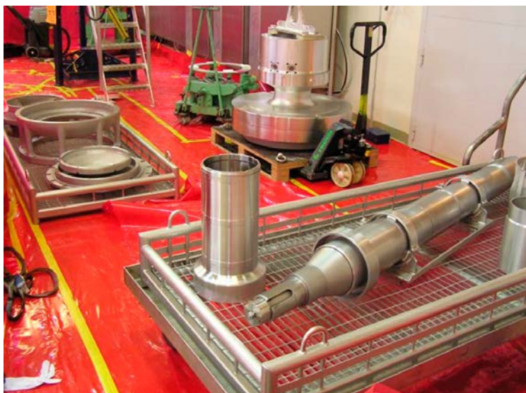
Figur 6-12. Pumpdelar efter kemisk dekontaminering.
