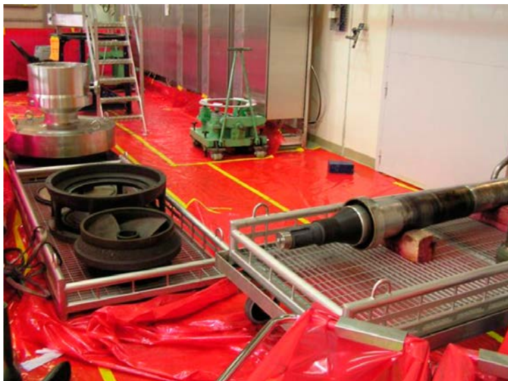
Figur 6-11. Pumpdelar före kemisk dekontaminering
