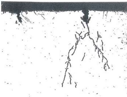
Figur 2-28. Transkristallina sprickor i ett austenitiskt rostfritt stål.
