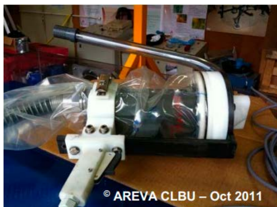
Figur 7-22. Handhållen laser från AREVA (Moggia 2013).
