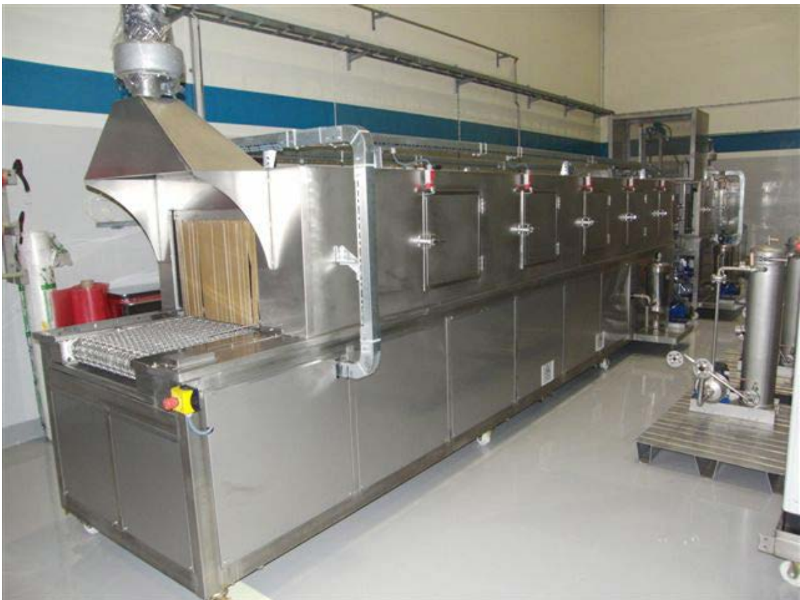
Figur A-8. Tunneltvätt Everest.
