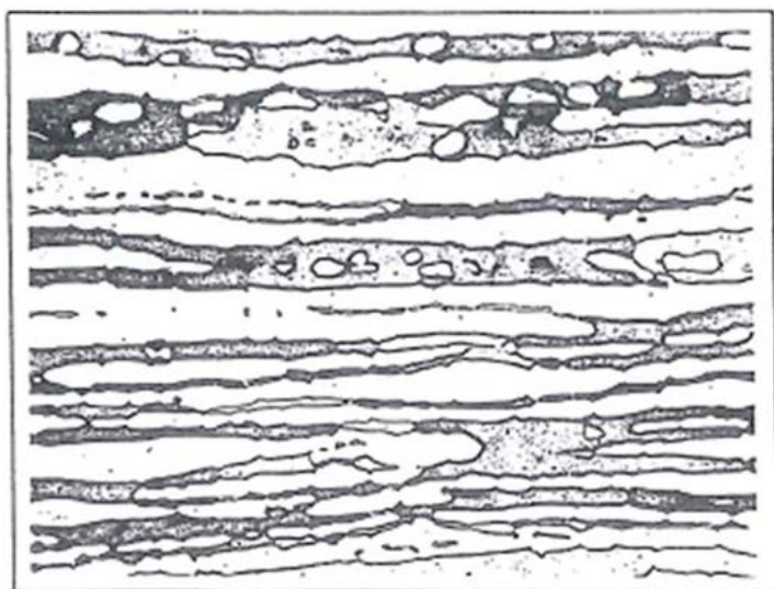
Figur 3-5. Ferrit-austenitisk (duplex) mikrostruktur.
