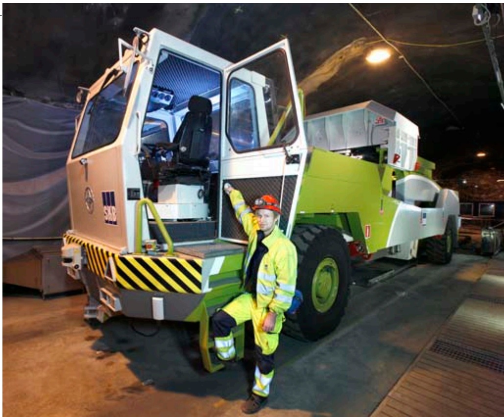
Deponeringsmaskinen i Äspölaboratoriet fick godkänt efter 200 testkörningar med maskinförare Andreas Högström.
