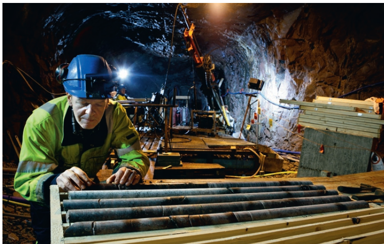
Kärnbörning pågår. Genom att bland annat studera borkärnor blir det enklare att hitta bra experimentplatser.
