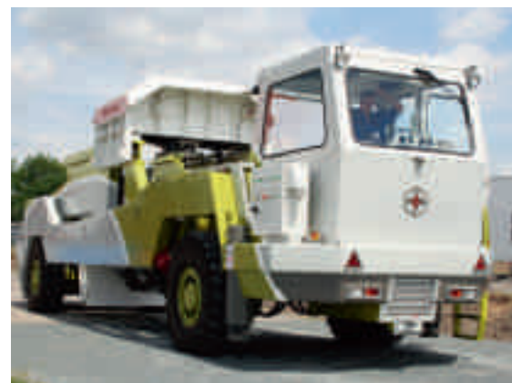
Den 75 ton tunga deponeringsmaskinen kan fjärrstyras men har även en styrhytt där den kan manövreras. Foto Berit Lundqvist
