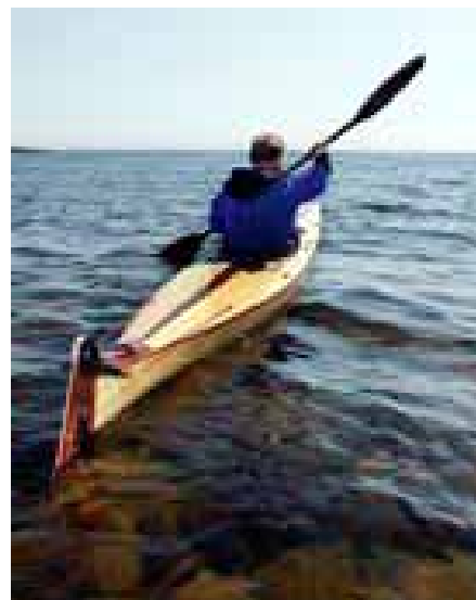
Kurt Hultgren har designat och byggt sin kanot själv. Den är gjord av gran med inläggningar i mahogny, wengé och björk.
