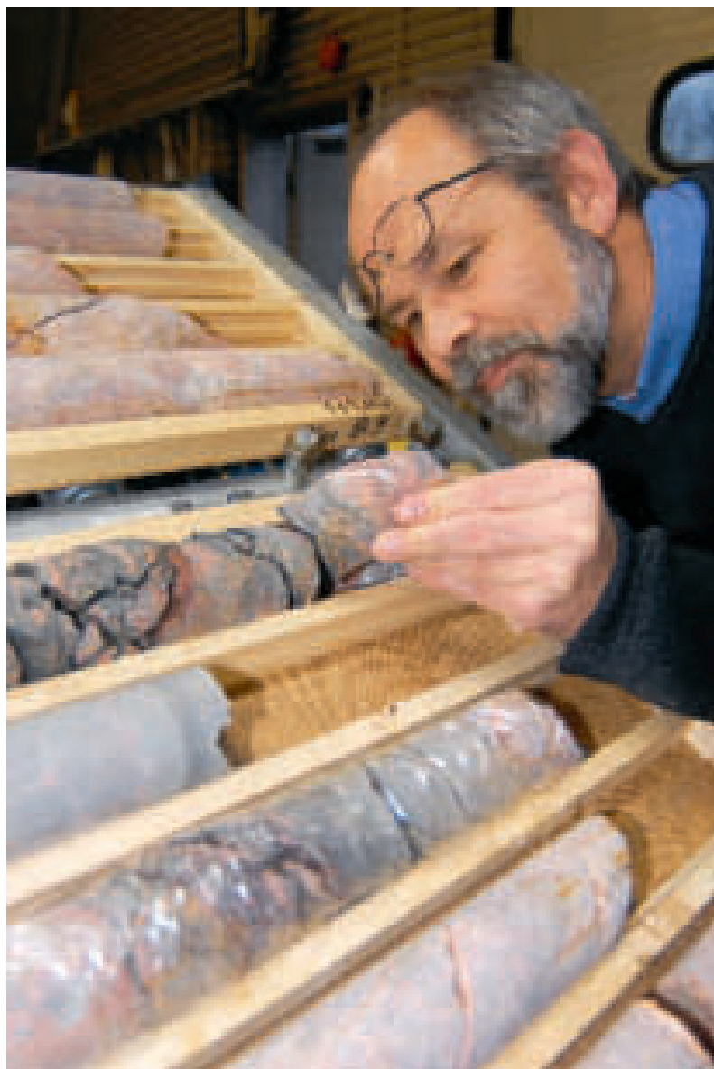
Platschef Kaj Ahlbom granskar borrhållningar från Singözonen. Här är berget betydligt mer uppsprucket än i området där förvaret eventuellt kan komma att placeras.
