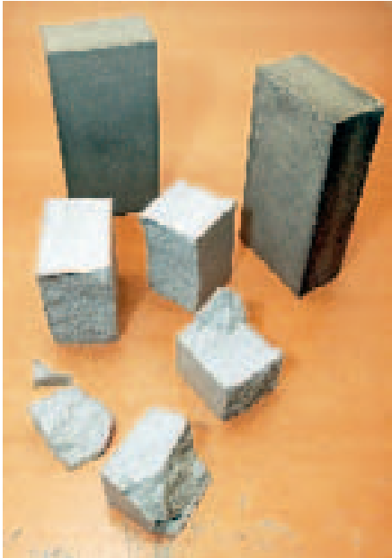
Pressade block av lera testas nu i Äspölaboratoriet.
