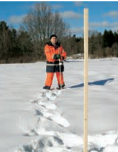
Det gäller att få ner käppar i marken trots tjälen. Senad Karameamidovic från Geocon förbereder geofysiska undersökningar.
