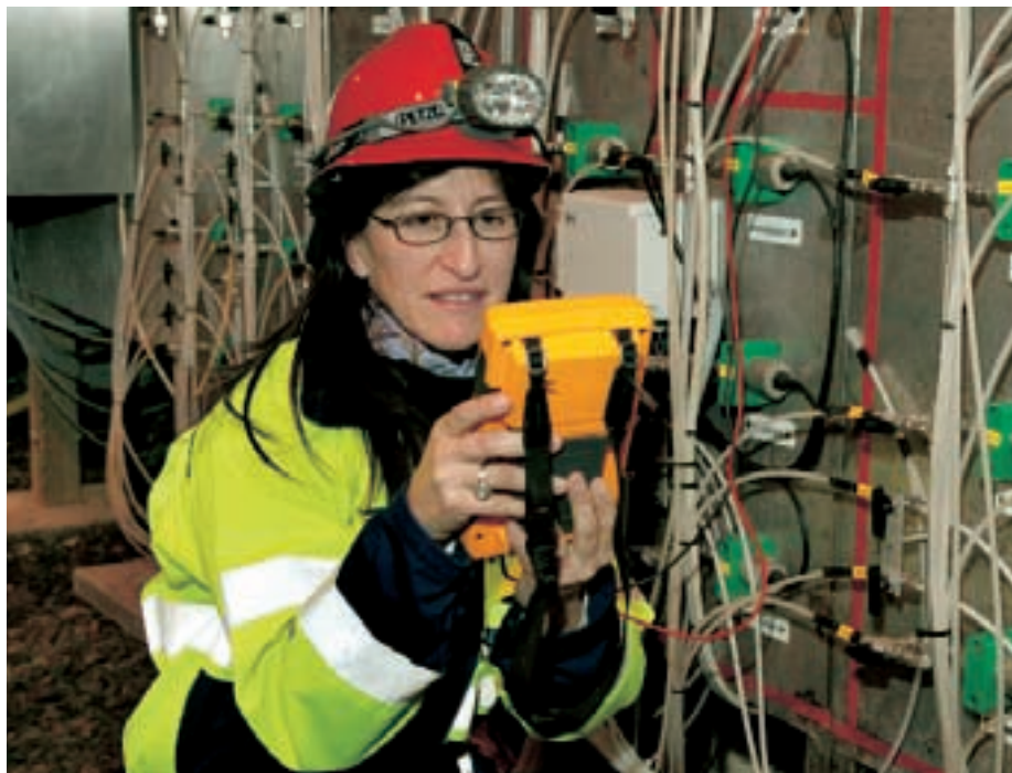
Instrumenten på tavlan känner av om grundvattentrycket i olika borrhål i Äspölaboratoriet förändras, förklarar geokemist Teresita Morales.
