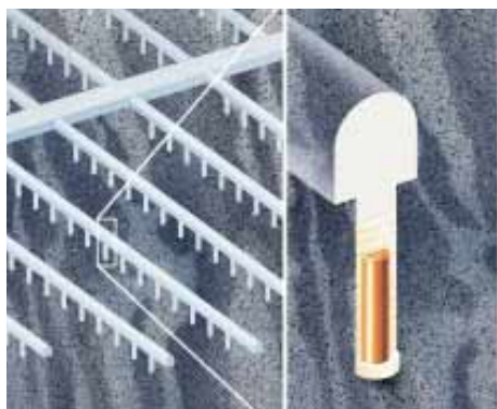
Bilden visar stående (vänster) och liggande (höger) deponering. Vid liggande deponering behövs inte deponeringstunnlarna. Deponeringshålen utgår direkt från transporttunnlarna.
