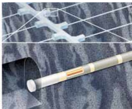
Bilden visar stående (vänster) och liggande (höger) deponering. Vid liggande deponering behövs inte deponeringstunnlarna. Deponeringshålen utgår direkt från transporttunnlarna.
