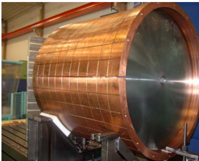
SKB:s kopparkapsel har hårdtestats i Tyskland.
