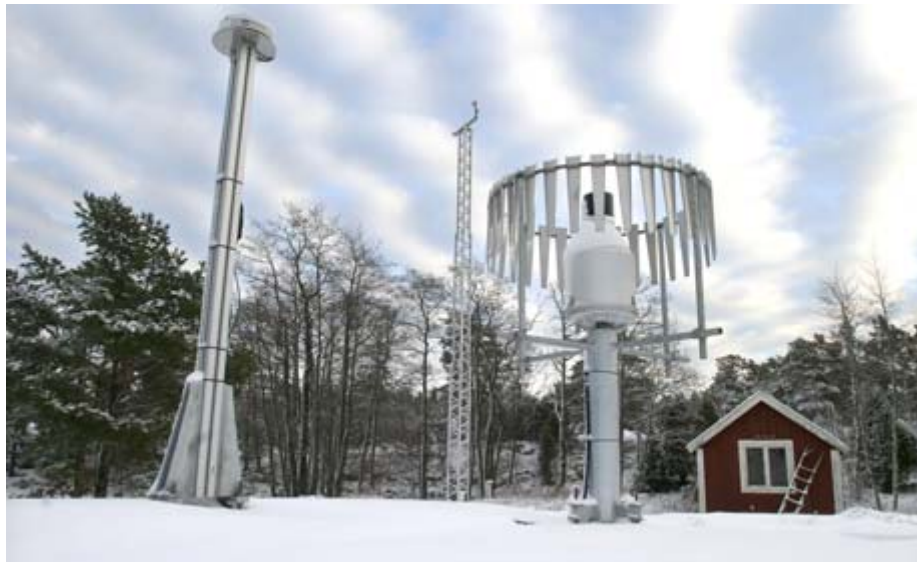
SKB:s väderstation på Äspö mäter både vind, relativ fuktighet och temperatur. Till höger syns nederbördsjämnaren med sitt spektakulära vindskydd.
