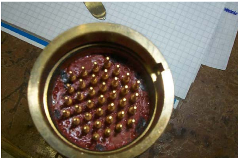
Figur 6-5. Brännmärken i gismapluggen, sannolikt bildade av ljusbågar.
