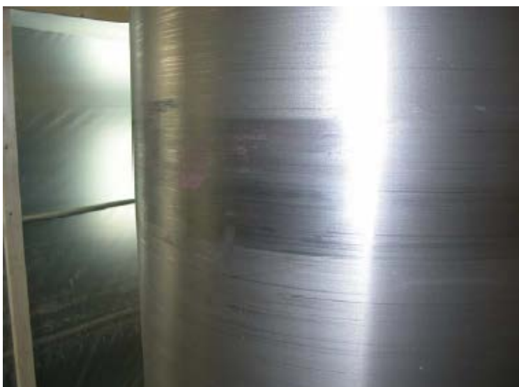
Figur 6-7. Den urlyfsta segjärnsinsatsens cylinderyta.
