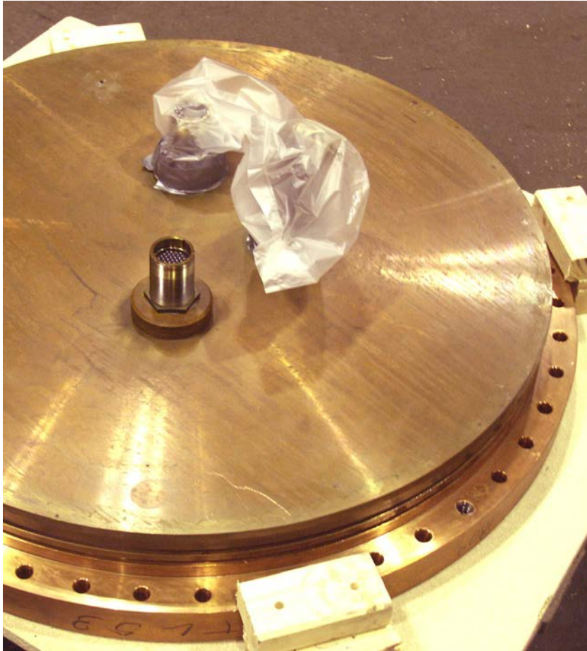
Figur 3-7. Locket till koppardelen av koppar/järnkapslen efter installation av genomföring och gisma-plugg. Locket är vänt upp och ner. Spåren med o-ringarna runt kanten av locket framgår också av bilden. (Fotografiet är taget efter fullskaleförsöket hos Kockums Industrier AB.)
