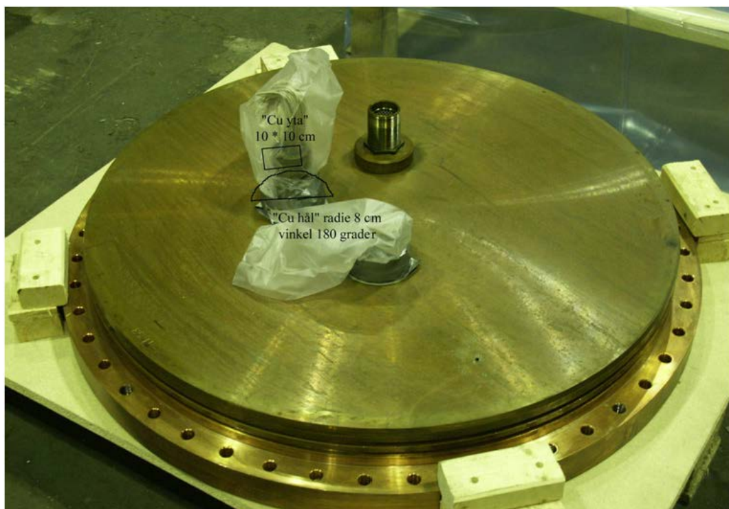
Figur 5-3. Undersidan av kopparlocket till kockumskapseln med områdena för strykproverna "Cu yta" och "Cu hål" inritade.
