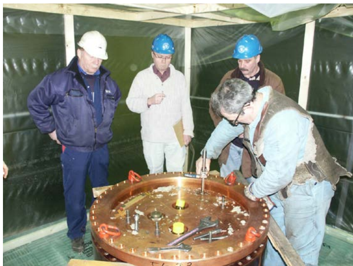
Figur 5-1. Övre delen av kockumskapseln samt omgivande väderskydd. Bilden är tagen i samband med att kopparlocket avlägsnas, och visar hur en del av gasprovtagningsutrustningen demonteras. Baktill i bilden från höger: Gunnar Ramqvist och Hans-Peter Hermansson. Isoleringen runt kapseln hade avlägsnats i detta skede.
