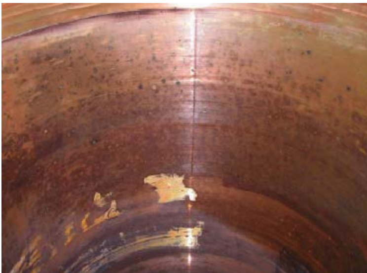
Figur 6-6. Detaljer på kopparbehållarens innervägg.
