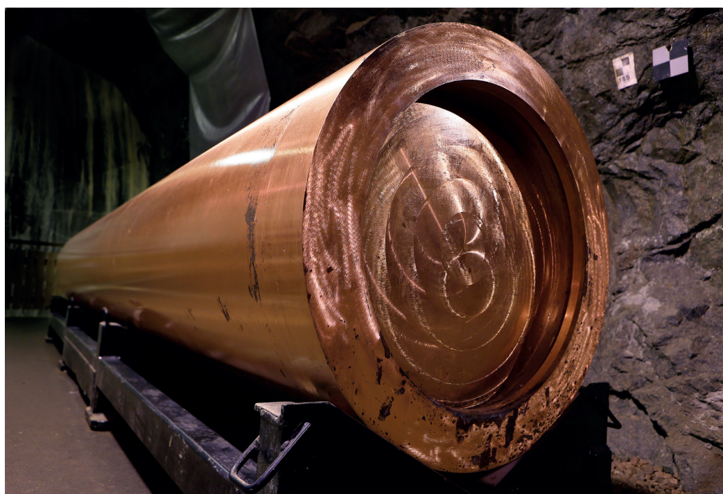
Kopparkapseln är fem meter lång och väger mellan 25 och 27 ton när den är fylld med bränsle.
