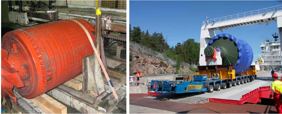
Figur 7-3. Exempel på material större än 1 ton som helt eller delvis kan vara föremål för friklassning.
