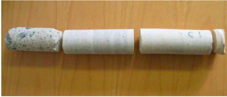
Figur 5-4. Borrprov för bestämning av inträngningsdjup.
