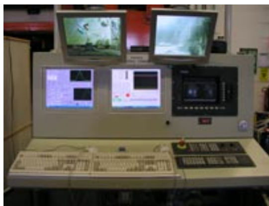
Figur 6-4. Manöverkonsol för EBW-systemet.
