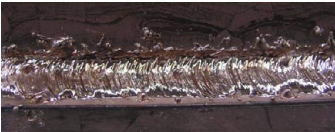
Figur 6-11. Locksvets L029, svetsad med oscillerande elektronstråle.
