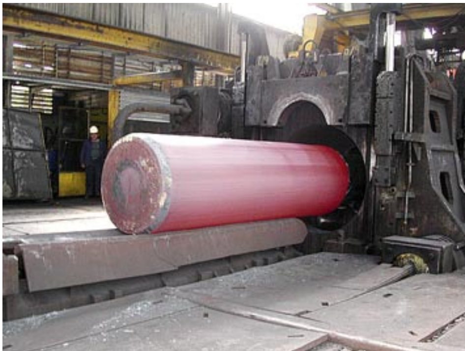
Figur 5-12. Tillverkning av kopparrör med integrerad botten genom dornpressning.
