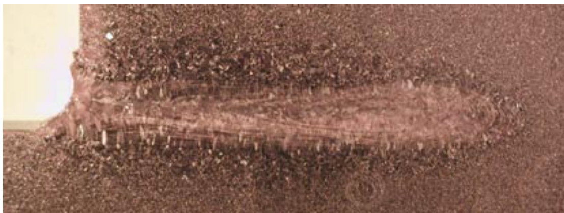
Figur 6-7. Makroprov av svets TB 122. Svetsförsök med oscillerande stråle.
