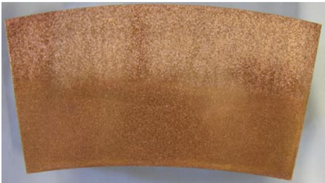
Figur 6-13. Locksvets L026. Längdsnitt i svetsen, längd cirka 200 millimeter. Den grova strukturen visar svetsens inträngning.
