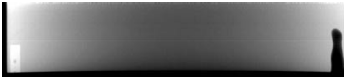
Figur 6-8. Radiografering av svets TB 122. Genom att avbryta svetsningen får man kvar den hålighet som hela tiden omger elektronstrålen under svetsningen i materialet. Detta ger en avbildning av elektronstrålens form. Den runda formen är viktig för att undvika rotfel.
