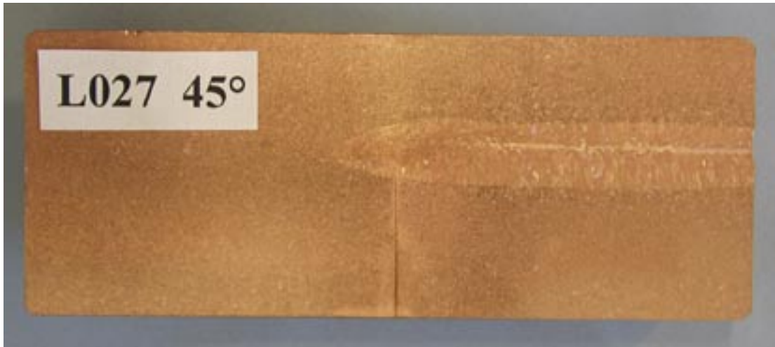
Figur 6-12. Locksvets L027. Tvärsnitt av svetsen. Makroprovet visar ett svetsdjup av 66 millimeter och svetsen har en rotradie på 1,5 millimeter, vilket minimerar risken för rotfel.
