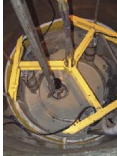
Figur 10-4. Fotot till vänster visar försöksuppställningen som användes vid uppslammningsförsöket – uppslamning sker i tanken i mitten. Till höger visas hur bentonitleran slammas upp med hjälp av en saltlösning.
