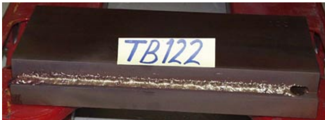
Figur 6-6. Svets TB 122. Svetsförsök med oscillerande stråle.
