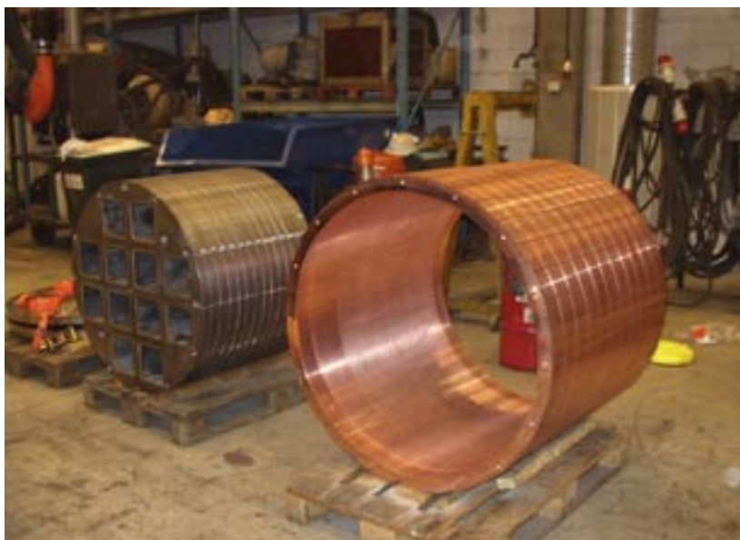
Figur 5-7. Del av gjuten insats och kopparrör för tryckprovning.
