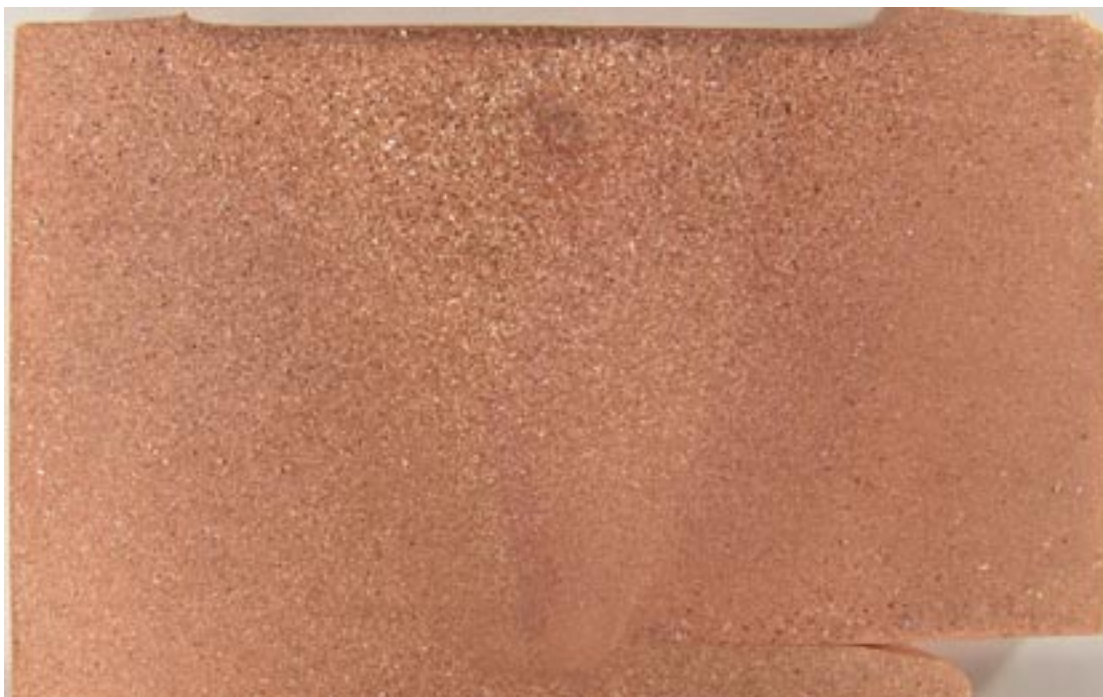
Figur 6-20. Makrosnitt av FSW-svets, som visar den finkorniga struktur som erhålls.
