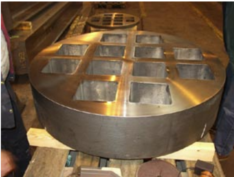
Figur 5-4. Kapade skivor ur gjuten insats för materialprovning.
