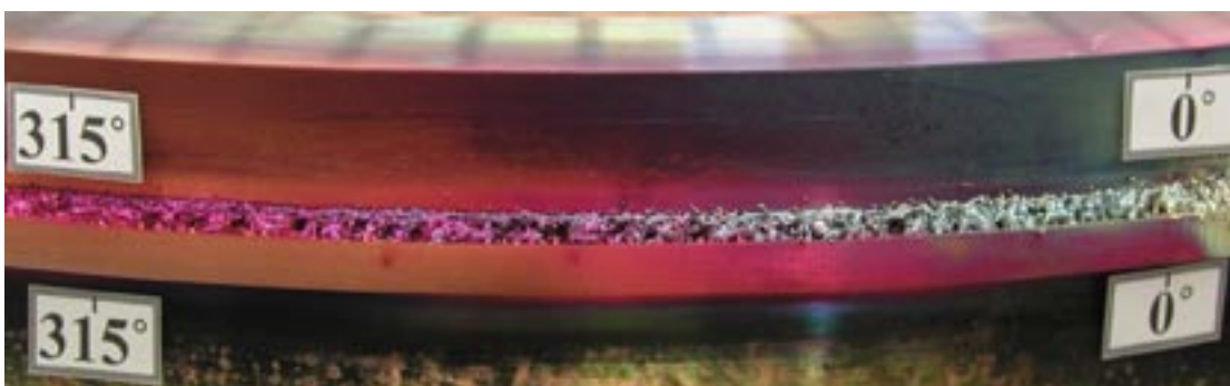
Figur 6-10. Locksvets L028. Parti svetsat utan oscillerande elektronstråle.
