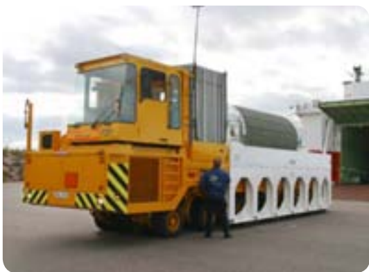
Figur 8-10. Terminalfordon som svarar för landtransporterna mellan anläggningarna, kärnkraftverken och Clab, och m/s Sigyn.
