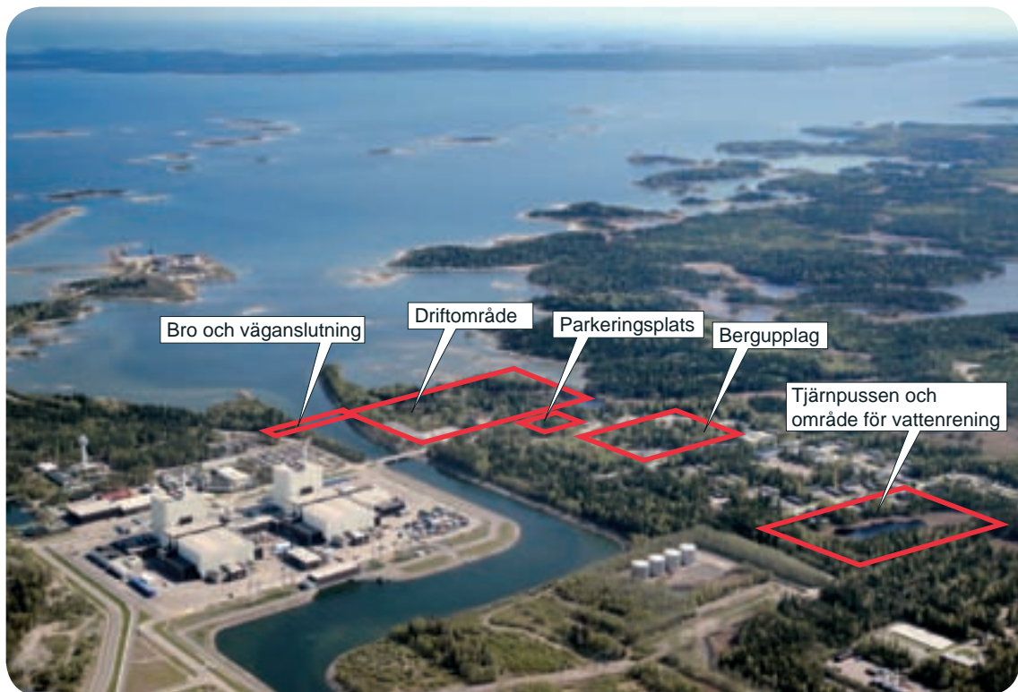
Figur 10-5. Placering av slutförvarsanläggningen samt ändringar i befintlig infrastruktur.
