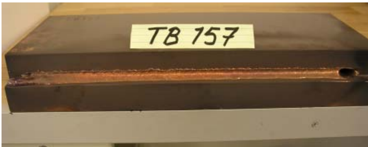
Figur 6: Svetsyta TB 157 med fryst "nyckelhål".
