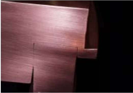
Figur 1: Genomskäring av kapsel med pålagt lock före svetsning.
