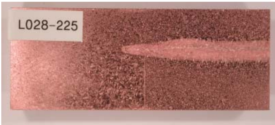
Figur 16: Makroprov locksvets L028 rotationsläge 225°, svetsdjup 67mm, rotradie 1.0mm.
