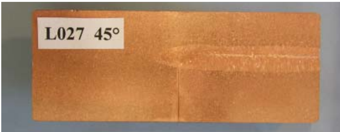
Figur 13: Makroprov locksvets nr L027 rotationsläge 45° svetsdjup 66mm, rotradie 1.5mm.
