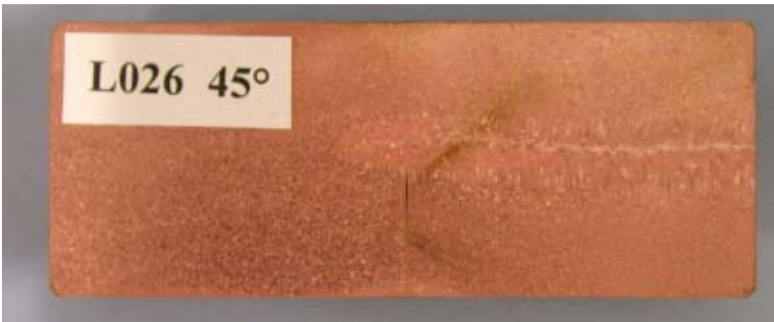
Figur 11: Makroprov locksvets nr 26 rotationsläge 45° svetsdjup 69mm och rotradie 1.9mm.
