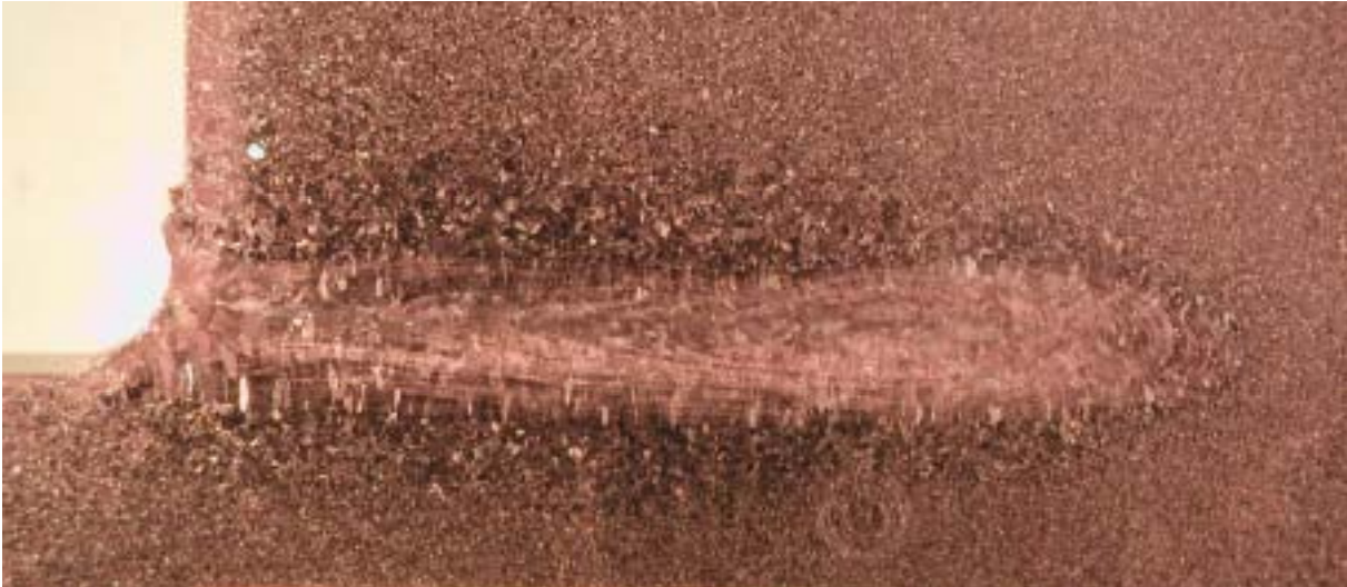
Figur 3: Makroprov av svets TB 122 svetsförsök med oscillerande stråle.
