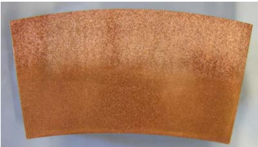
Figur 12 längdsnitt i svetsgods.
