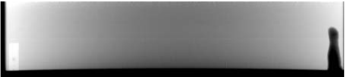
Figur 4: Radiografering av svets TB 122 med bild på fryst "nyckelhål".
