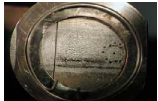
Figur 27: Probe för mätning av elektronstråle "pin hole" Ø0.3mm.
