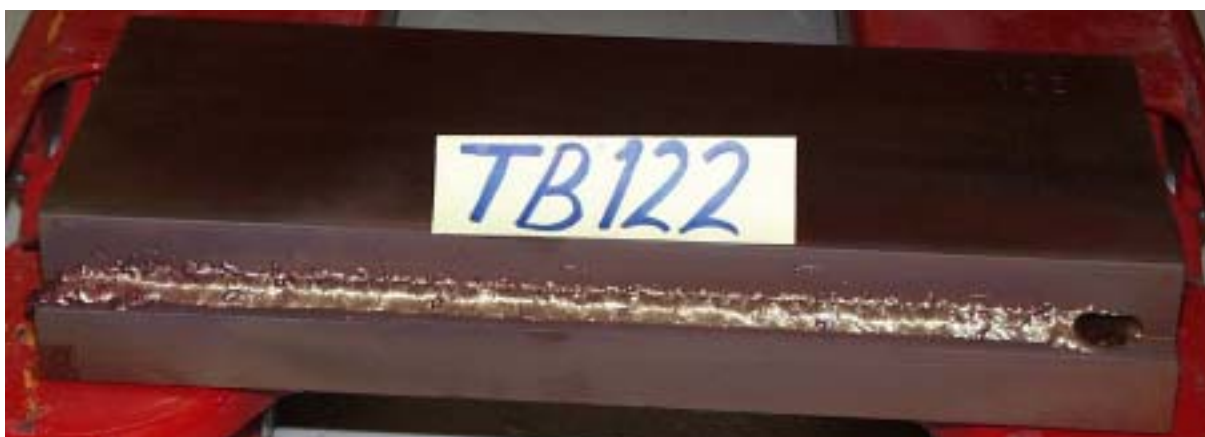
Figur 2: Bild av svets TB 122 svetsförsök med oscillerande stråle.
