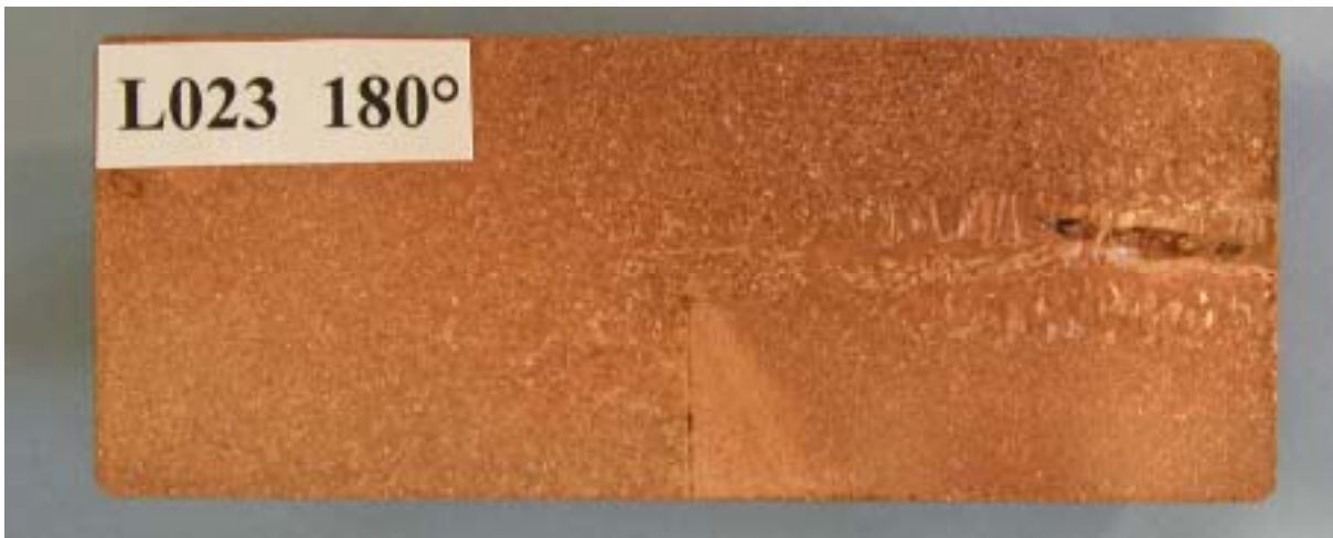
Figur 8: Makroprov locksvets nr 23 rotationsläge 180° med ytnära kavitet.
