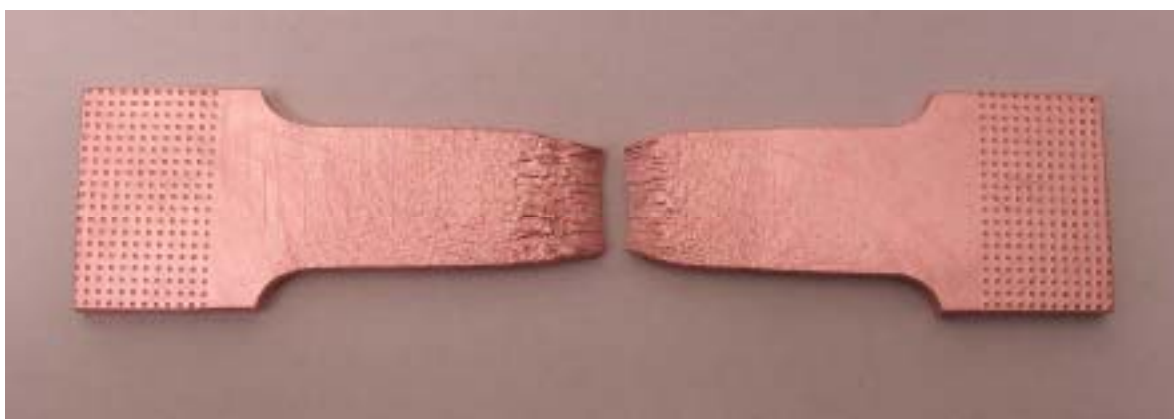
Figur 19: Dragprov locksvets L028 rotationsläge 310°.
