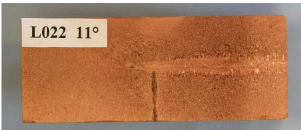
Figur 7: Makroprov locksvets nr 22 rotationsläge 11° Spetsig rot med defekter.
