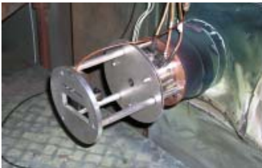
Figur 26: Hållare och spole monterade på elektronkanonen.
