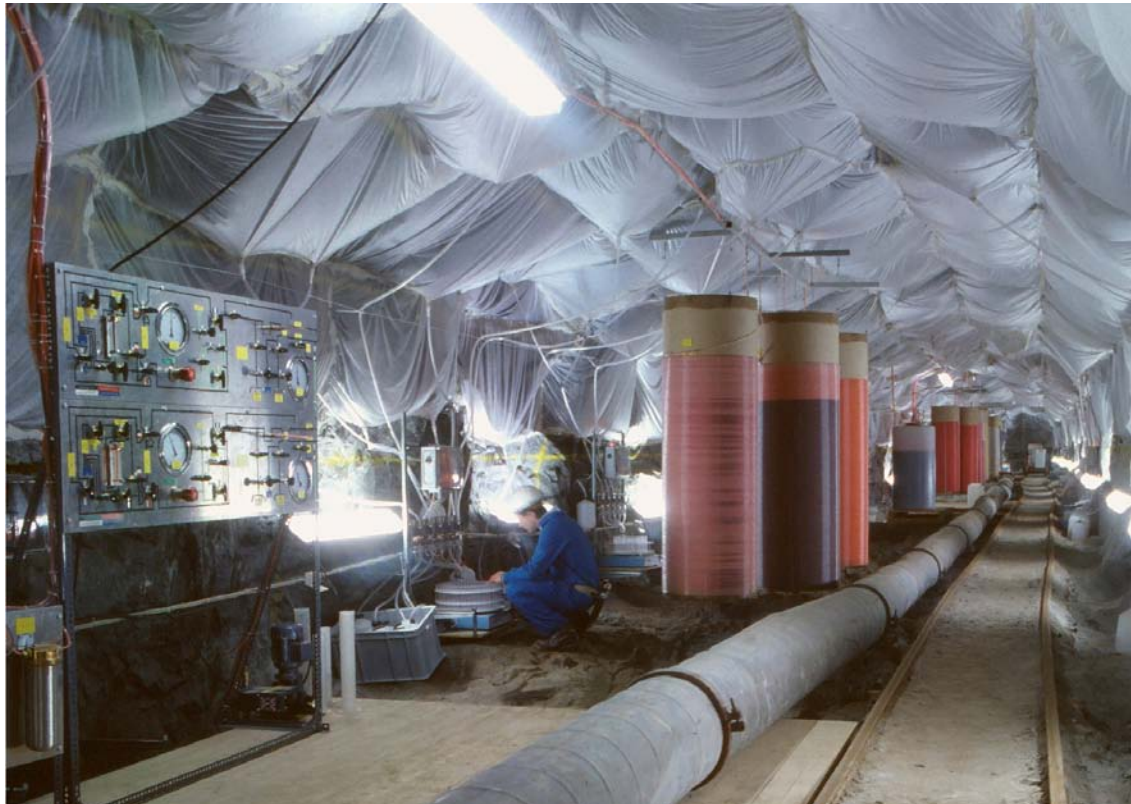
Figur 10-1. Spårämnesförsök under Stripa-projektet.
