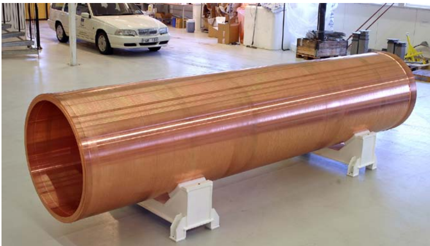
Figur 9-5. Extruderat och maskinbearbetat kopparrör (Fud-program 2004).
