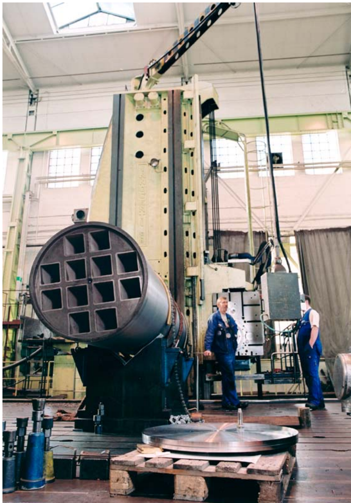
Figur 9-4. Färdigbearbetad insats och stållock till insats (Fud-program 2004).
