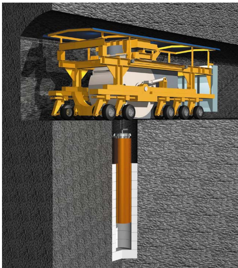
Figur 8-6. SKB har låtit tillverka en prototyp till en deponeringsmaskin (Fud-program 2001).
