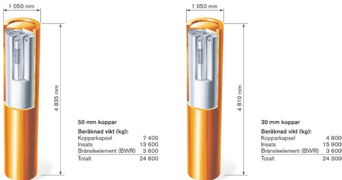
Figur 8-5. Mått och viktangivelser för kapsel med 50 mm och 30 mm vägg tjocklek (Fud-program 2001).
