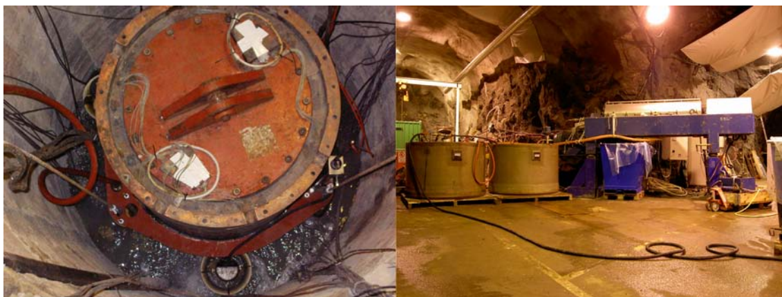
Figur 9-14. Demonstration av friläggningen av en kopparkapsel med den hydrodynamiska metoden i Åspölaboratoriet. Till vänster visas uppsplamningen av bentonitbufferten och till höger visas utrustningen för avvattning. (Fud-program 2007.)
