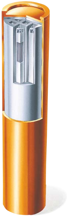
Figur 8-2. Kopparkapsel med gjuten insats av järn för BWR-bränsle (Fud-program 98).
