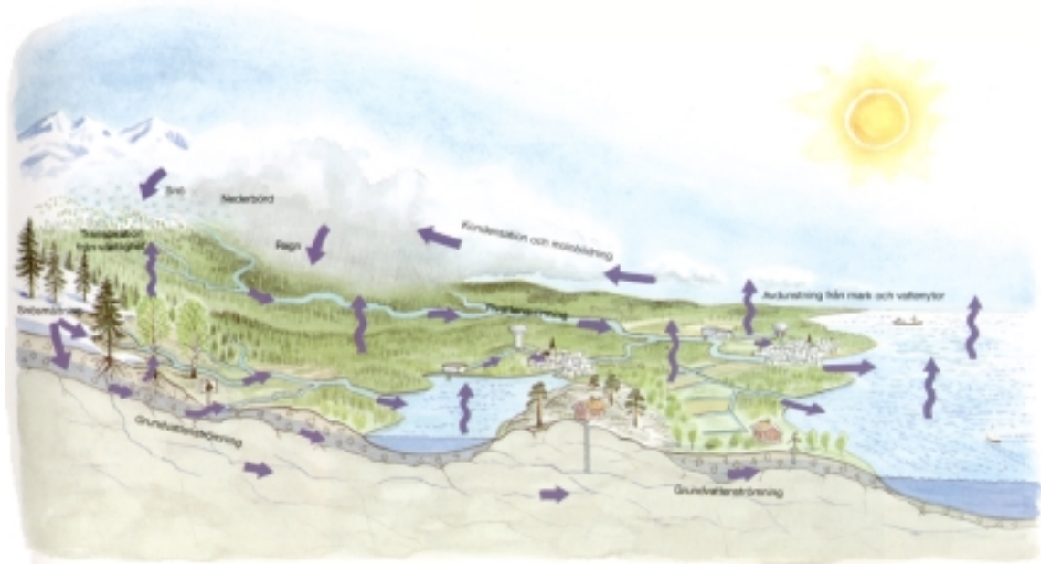
Figur 3-1. Vattnets kretslopp. Sötvatten i form av nederbörd samlas i sjöar, floder, bäckar eller i grundvattenmagasin. Detta vatten förs mot haven. Vattenförrådet i atmosfären förnyas genom avdunstning (evaporation) från alla ytor och genom växternas transpiration. Människan hämtar sitt vatten från rinnande vattendrag, sjöar, uppdammda reservoarer eller från grundvattenmagasin (från SHR Bildarkiv).
