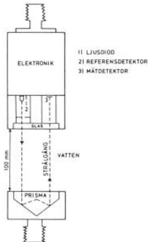
Figur A-1. Principskiss av transmissionsmätaren.
