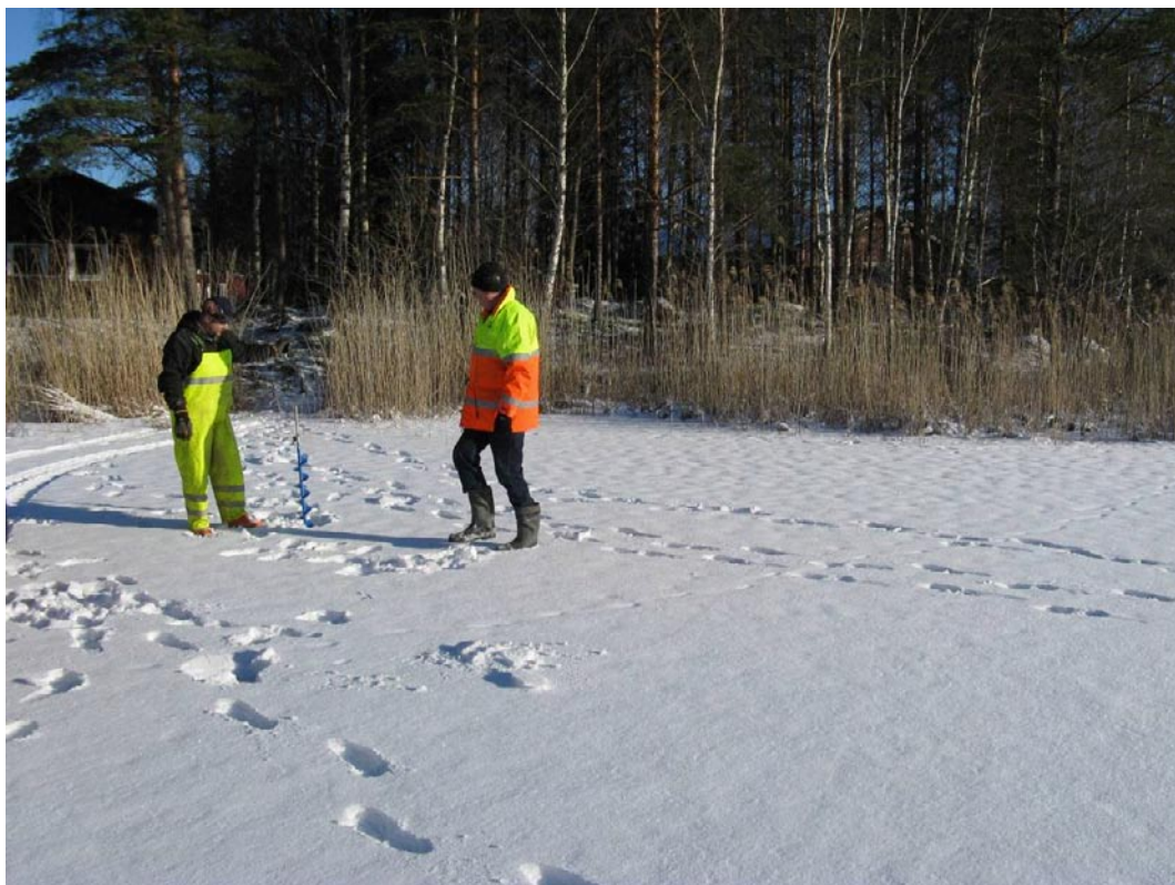
Figur 3-1. Inför val av exakta borrlägen genomfördes försondering genom is. Bilden visar förberedelser inför försondering och installation av pegelrör SFM000119 i objekt 8 (sjön Tjärnpussen), belägen precis väster om Barackbyn (se figur 5-1).
