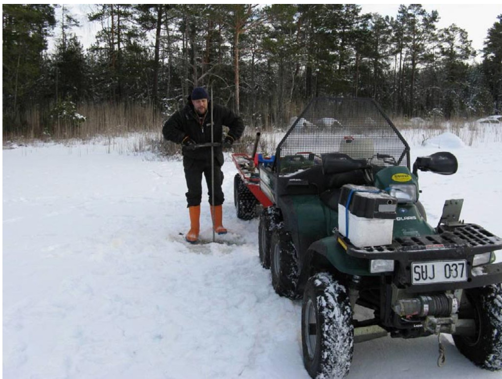
Figur 3-2. Försondering med sticksond i våtmarksobjekt 18 (Kungsträsket), beläget väster om sjön Bolundsfjärdens södra del (se figur 5-1).
