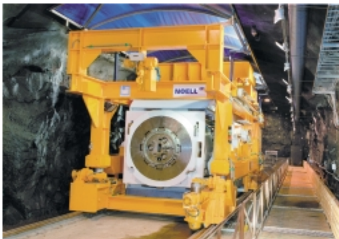
Figur 3-3. Demonstrationsanläggningen i Äspö-laboratoriet med uppställd deponeringsmaskin.
