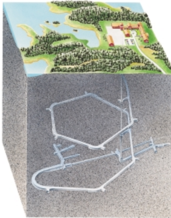
Figur 3-2. Principiell modell av Äspö-laboratoriet.
