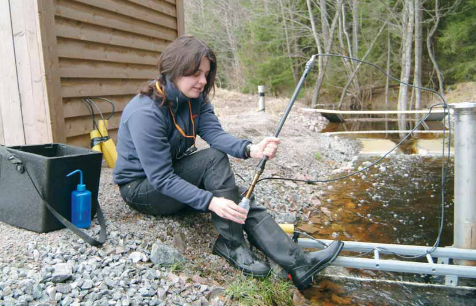
Cecilia Berg från Geosigma mäter vattnets elektriska ledningsförmåga vid en av områdets mätstationer för vattenflöden.
