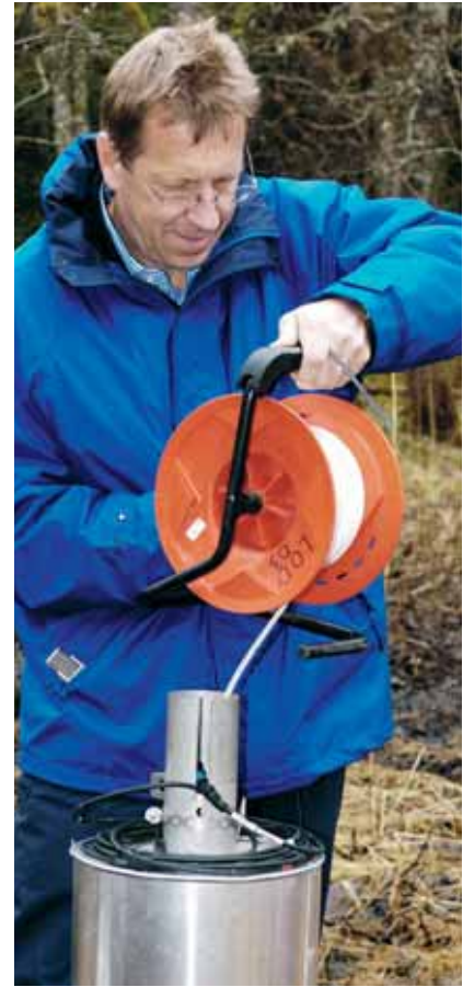
Hydrogeolog Per-Olof Johansson, Artesia Grundvattenkonsult, mäter vattennivån i jordlagren.
