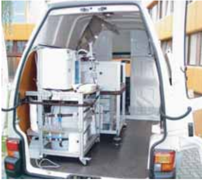
Mätutrustningen för laserinducerad nedbrytning av kolloider är mobil. På så sätt kan man mäta direkt i borrhålen.
