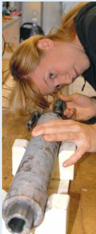
Stina Åstrand, Vattenfall Power Consultants, mäter bergspänningar med överborrningsteknik.
