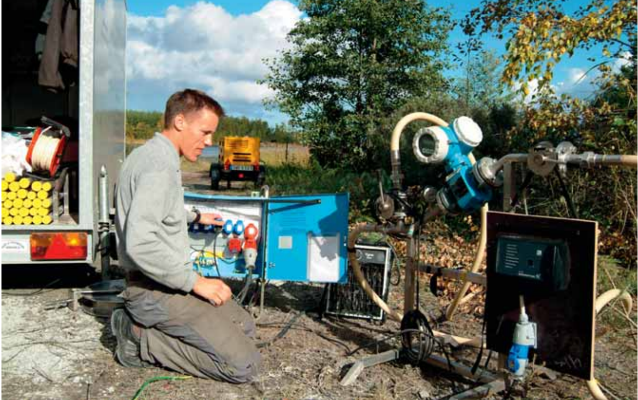
Tomas Svensson från Geosigma förbereder för pumptest och flödesloggning i hammarborrhål HFM22.
