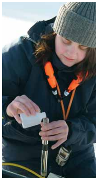
Cecilia Berg från Geosigma tar prov på gasbubblor från bottenlager i Bolundsfjärden. Detta gör man för att analysera gaserna kväve, syre, väte, helium, koloxid, koldioxid, metan samt kolväten.
