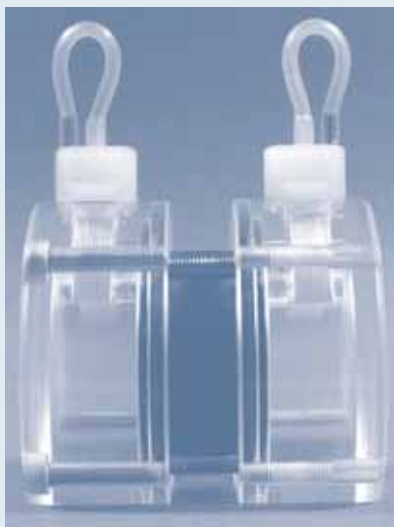
Bestämning av diffusivitet i laboratorium.
