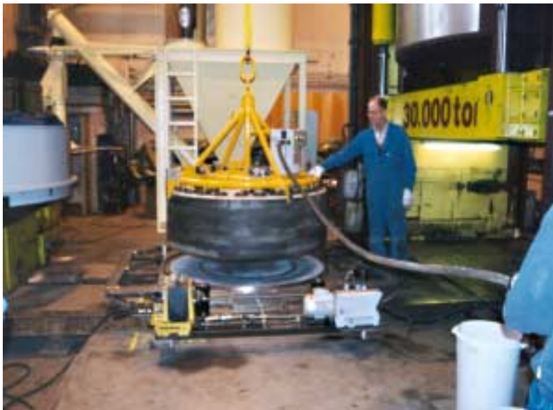
Figur 3. Ovanstående foton visar pressning av bentonitblock för experimenten i Äspö. På det övre syns hur pulvret fylls i formen och på det undre syns det färdigpressade blocket lyftas.
