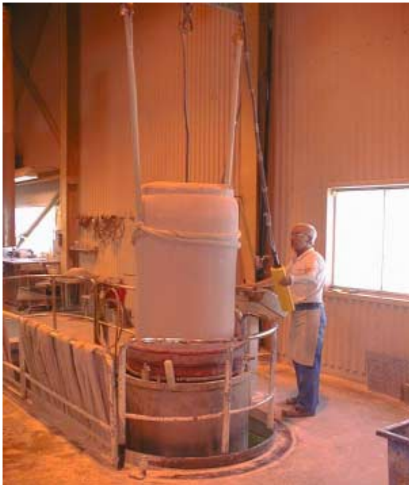
Figur 4. Isostatisk pressning av isolatorer vid företaget Ifö, Bromölla.
