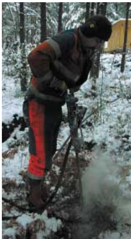
Figur 6. Seismik. a) Borrhål för seismiksprängning i håll. Sprängämnet (del av en Dynamexpatron) ligger apterat färdigt för placering i borrhålet. b) Seismograf med operatör. Foto Carl-Axel Triumph
