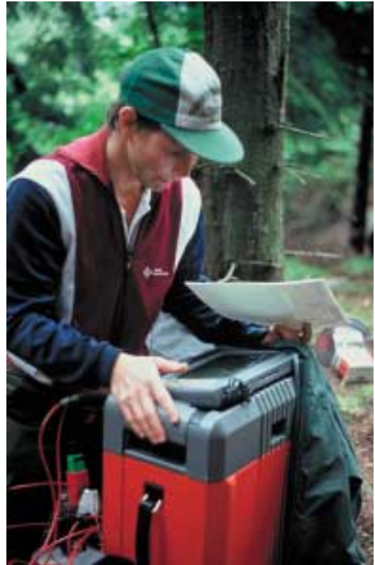
Figur 6. Seismik. a) Borrhål för seismiksprängning i håll. Sprängämnet (del av en Dynamexpatron) ligger apterat färdigt för placering i borrhålet. b) Seismograf med operatör. Foto Carl-Axel Triumph
