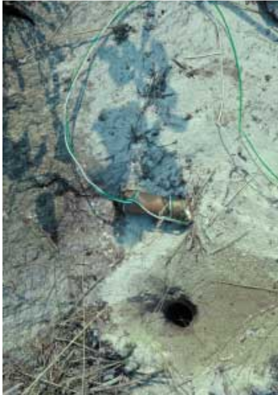
Figur 6. Seismik. a) Borrhål för seismiksprängning i håll. Sprängämnet (del av en Dynamexpatron) ligger apterat färdigt för placering i borrhålet. b) Seismograf med operatör. Foto Carl-Axel Triumph
