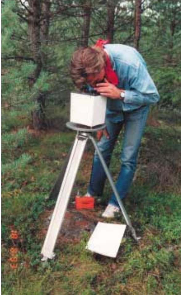
Figur 5. Gravimetri. Dessa mätningar utförs i ett glest observationsnät över Forsmarksområdet med omgivning. Punktavståndet är 0,5–1 kilometer. Vintertid kan mätningar ske på is. Mätpersonalen uppehåller sig som mest en halvtimme vid varje punkt. Foto Sven Aaro/SGU
