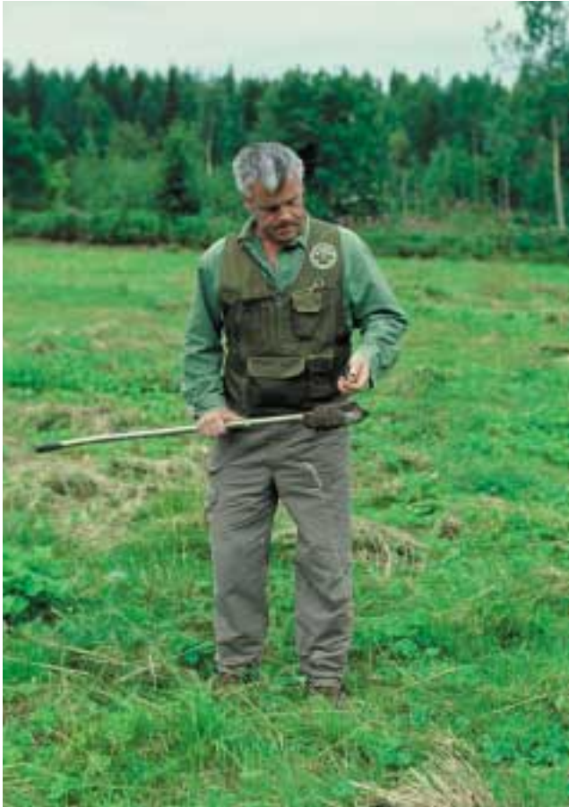
Figur 3. Jordprovtagning. Vid provtagning av markens kemi eller vid jordartsstudier används olika typer av bandhållna jordprovtagare där ett prov tas vid ytan eller någon decimeter ned i marken.
