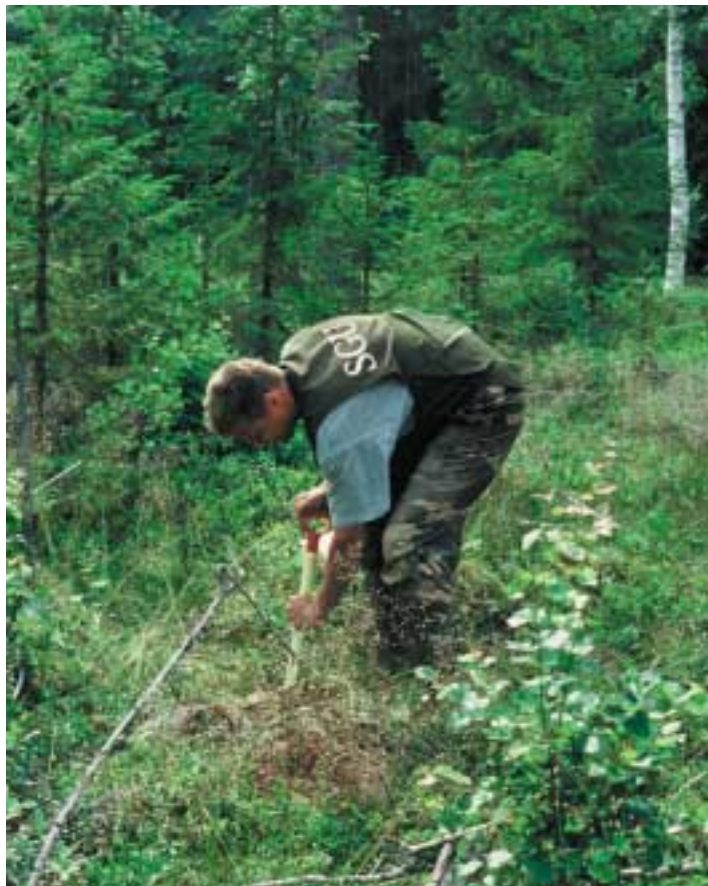
Figur 4. Jordartskartering. Jordprov på ett par liter tas upp med spade.
