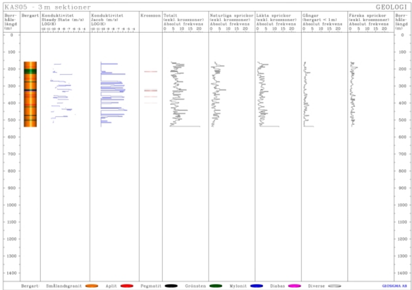
Figur 4-14. Översiktsbild för borrhål KAS05 – 3 meters mätskala.
