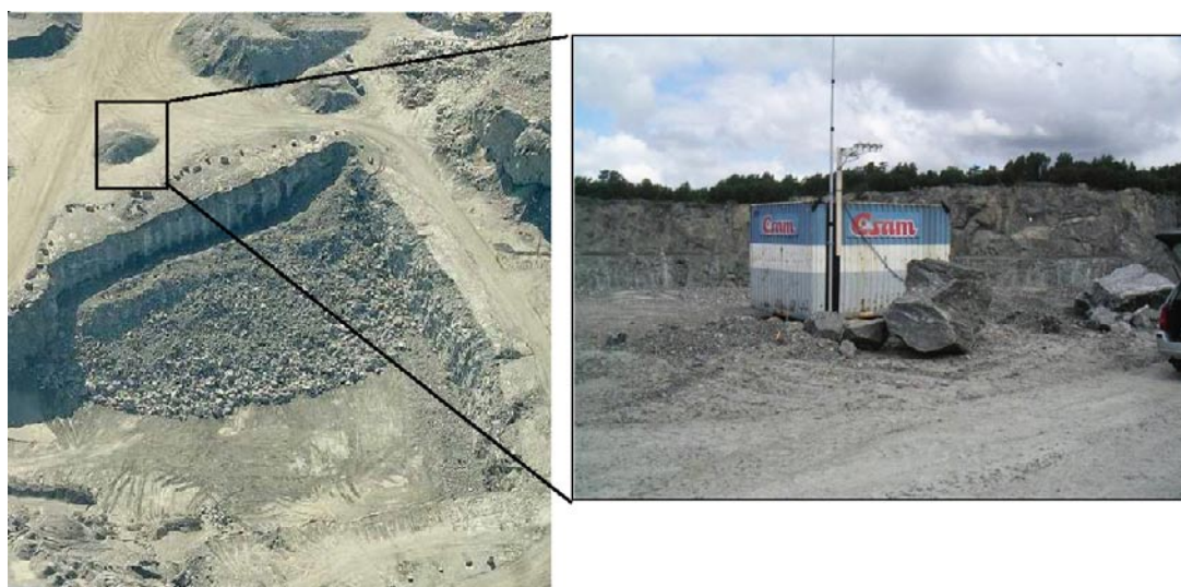
Figur B5-3. Lokalisering av mätkontinern samt förstoring. Partikelmätningarna genomfördes på ca 2 m höjd (lilla masten) och vindmätningarna på ca 5 m höjd (stor mast sträcker sig ovanför bilden).
