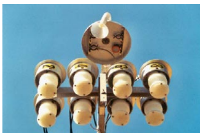
Figur B5-1. IVL:s mät huvud för partikelmätning ( PM_{10} ) (Foto: Karin Persson, IVL).
