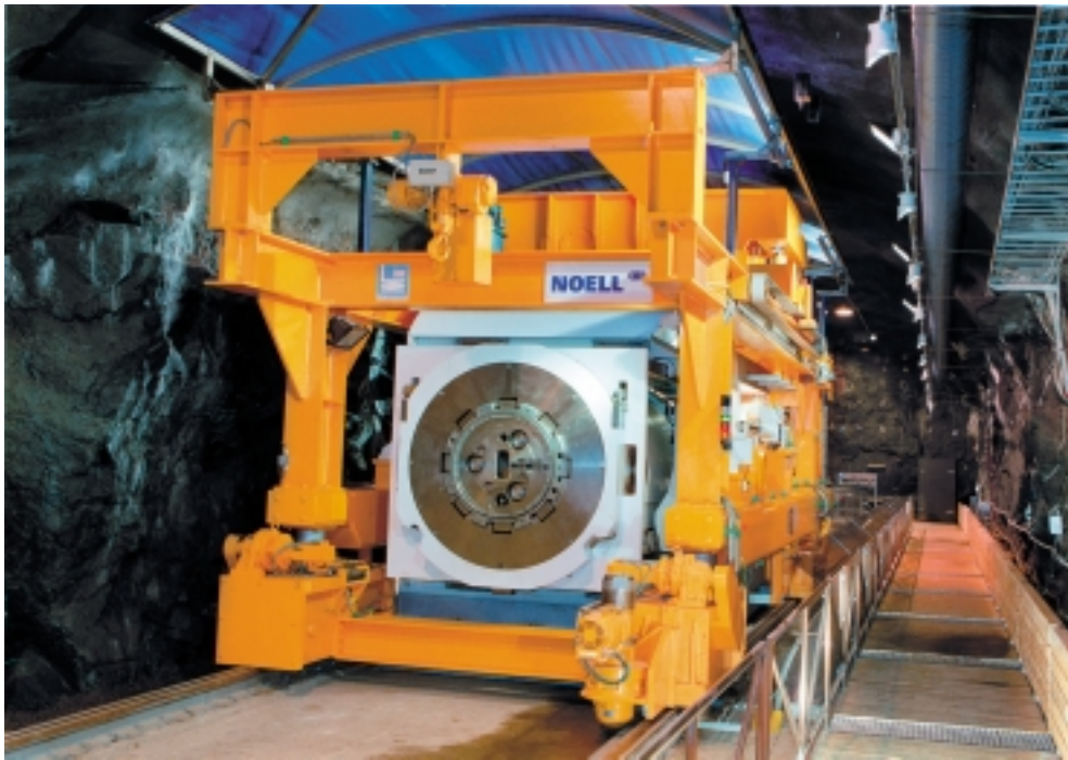
Figur 6-7. Deponeringsmaskinen i nuvarande utformning i demonstrationsanläggningen i Äspölaboratoriet. I mitten ses strålskyddstuben i vilken kapseln transporteras fram till deponeringshålet.
