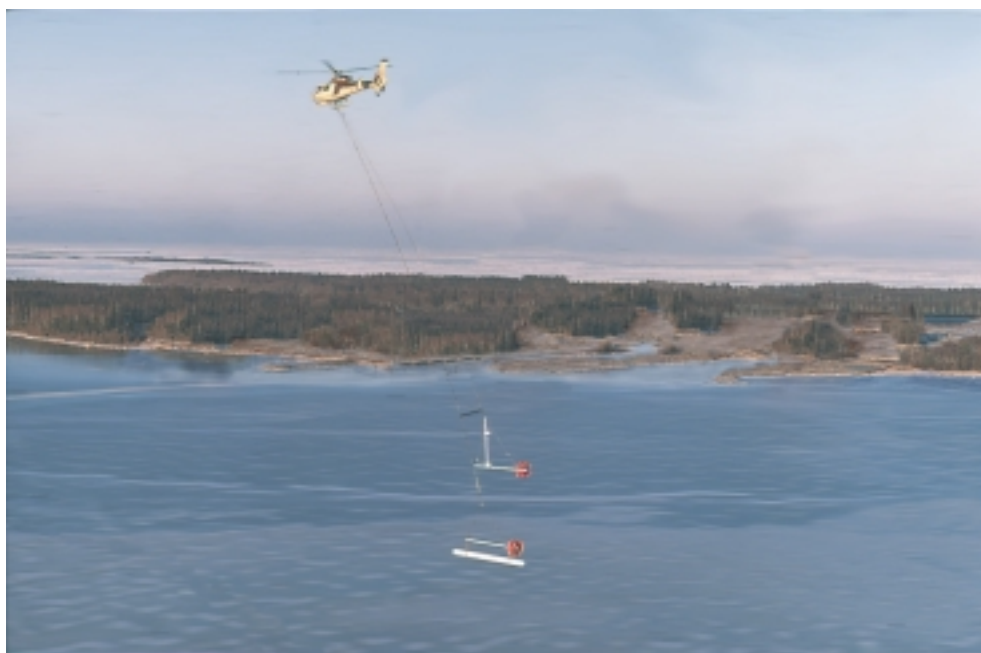
Figur 13-6. Geofysiska mätningar från helikopter. Instrument som registrerar bland annat berggrundens magnetiska och elektriska egenskaper placeras i mätsonder under helikoptern. (Bild från mätningar i Finland, fotomontage.)
