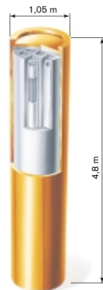
Figur 6-3. Kapsel för använt kärnbränsle.
