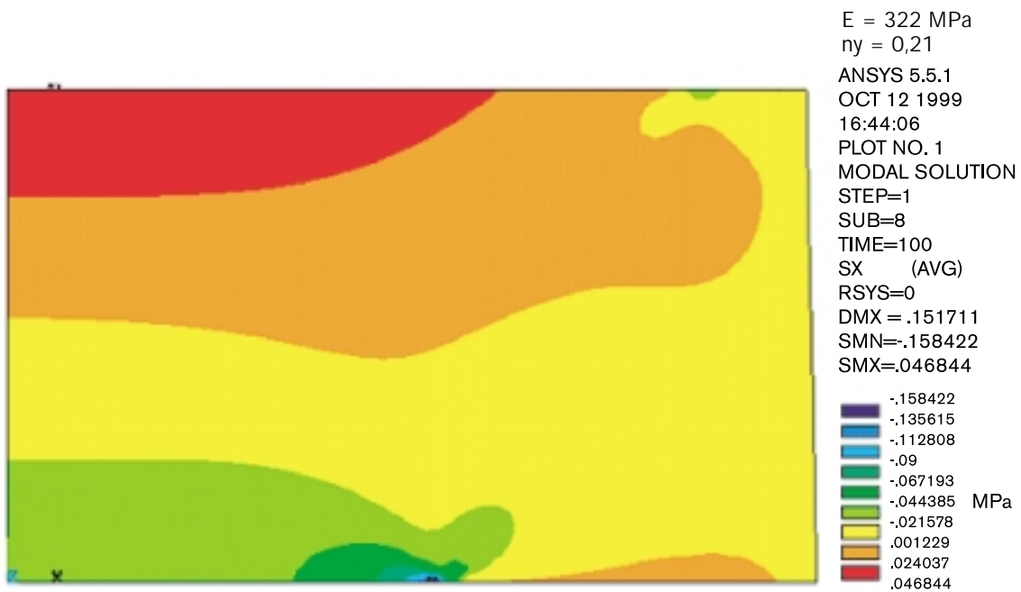
Figur B6-4. Radiell spänningsfördelning vid planavvikelse = 0,5 mm och last = 1 ring.
