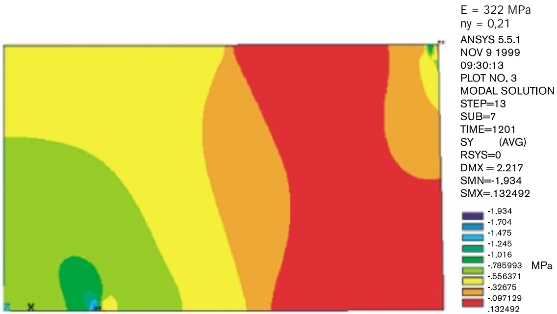
Figur B6-13. Axiell spänningsfördelning vid planavvikelse = 3 mm och last = 12 ringar + kapselvikt.
