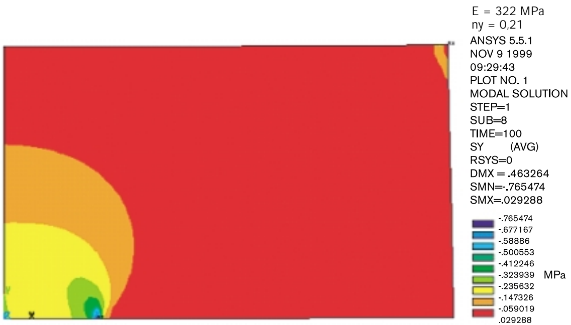
Figur B6-9. Axiell spänningsfördelning vid planavvikelse = 3 mm och last = 1 ring.
