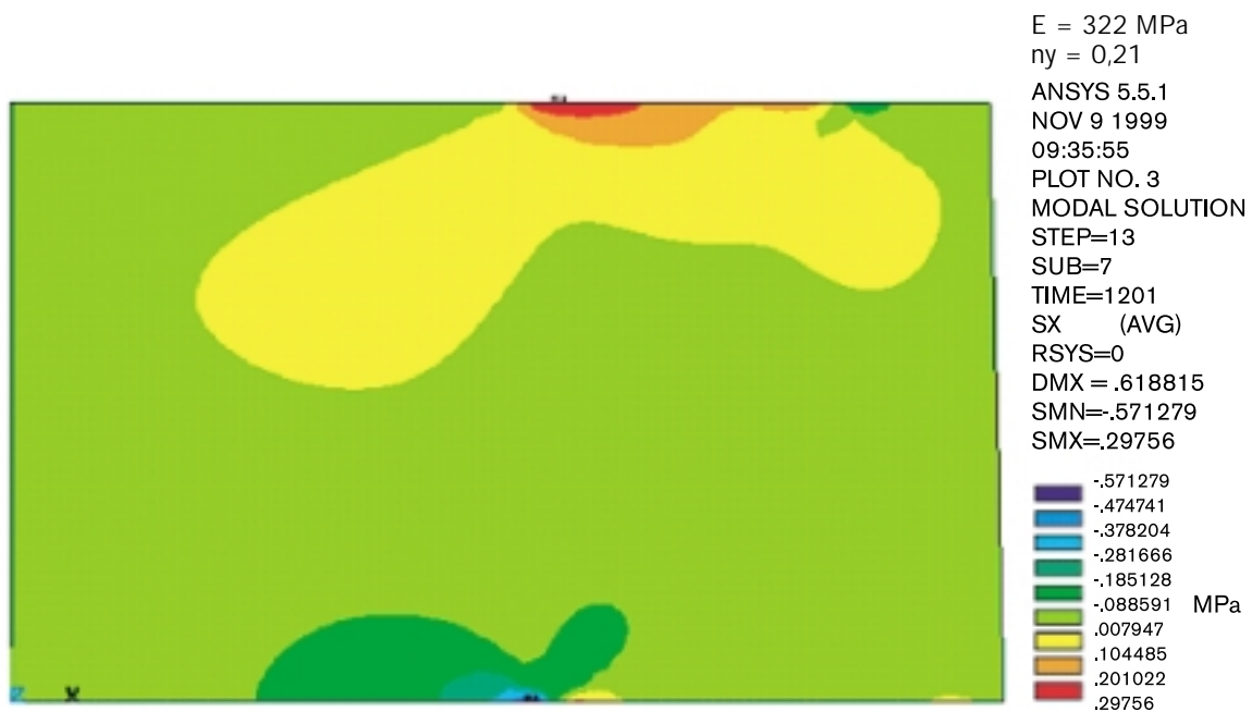
Figur B6-8. Radiell spänningsfördelning vid planavvikelse = 0,5 mm och last = 12 ringar + kapsel-vikt.
