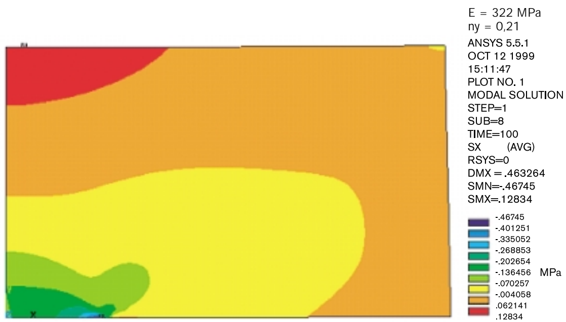
Figur B6-10. Radiell spänningsfördelning vid planavvikelse = 3 mm och last = 1 ring.
