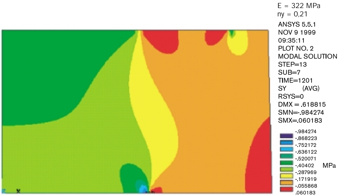
Figur B6-7. Axiell spänningsfördelning vid planavvikelse = 0,5 mm och last = 12 ringar + kapsel-vikt.
