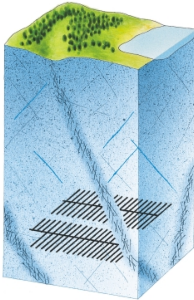
Figur 7-1. Det är en fördel om en stor del av bergmassan i deponeringsområdet har en vattengenomsläpplighet ( K ) som är mindre än 10^{-8} m/s (i skalan 30 m). Sprickzoner (regionala och lokala större) med stora flöden tillåts normalt inte passera enskilda deponeringstunnlar.
