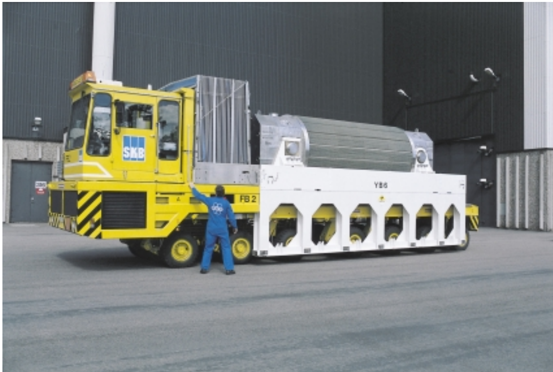
Figur 1-1. Transportbehållare för bränsleelement på transportfordon.
