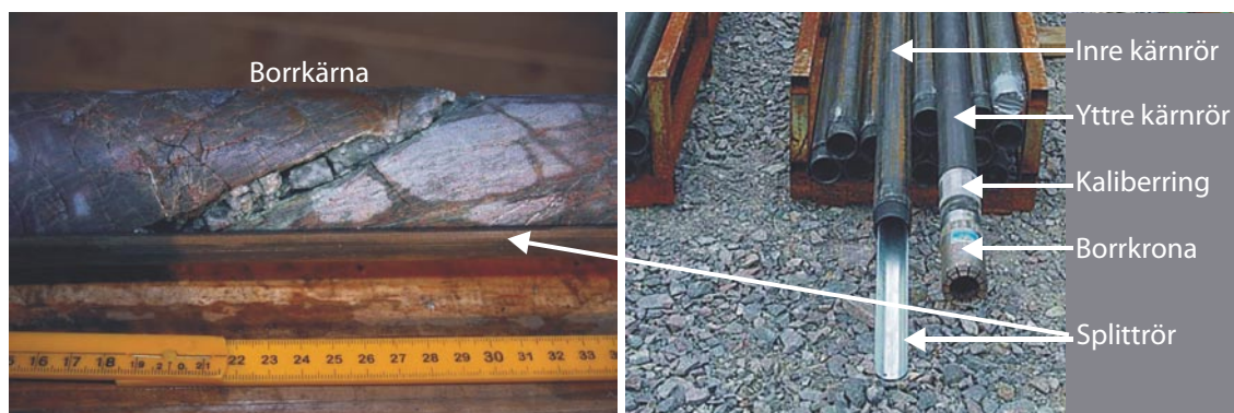
Figur 4-3. Inom platsundersökningarna har trippelrör från två olika tillverkare av borrarutrustning använts, Hagby WL 76 och Corac N50/3. Uppbyggnaden av kärnröret är likartad för bägge systemen. Något av dessa system kommer att användas även vid SFR-borrningarna.
