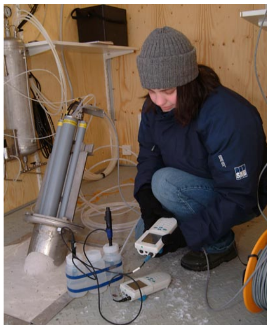
Figur 8-2. a) Enkel flödescell för mätning av fält-EC, fält-pH och vattentemperatur on-line. b) Mätkammare i ytChemmac systemet med elektroder och givare för mätning av fält-EC, fält-pH, redoxpotential, löst syre och vattentemperatur.
