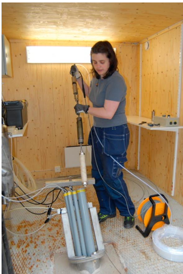
Figur 8-1. Sänkning av utrustning för pumpning av vatten i ett vattenståndsror från en installerad cirkulationssektion i ett kärnborrhål. Utrustningen består nerifrån räknat av filter, liten manschett och pump.
