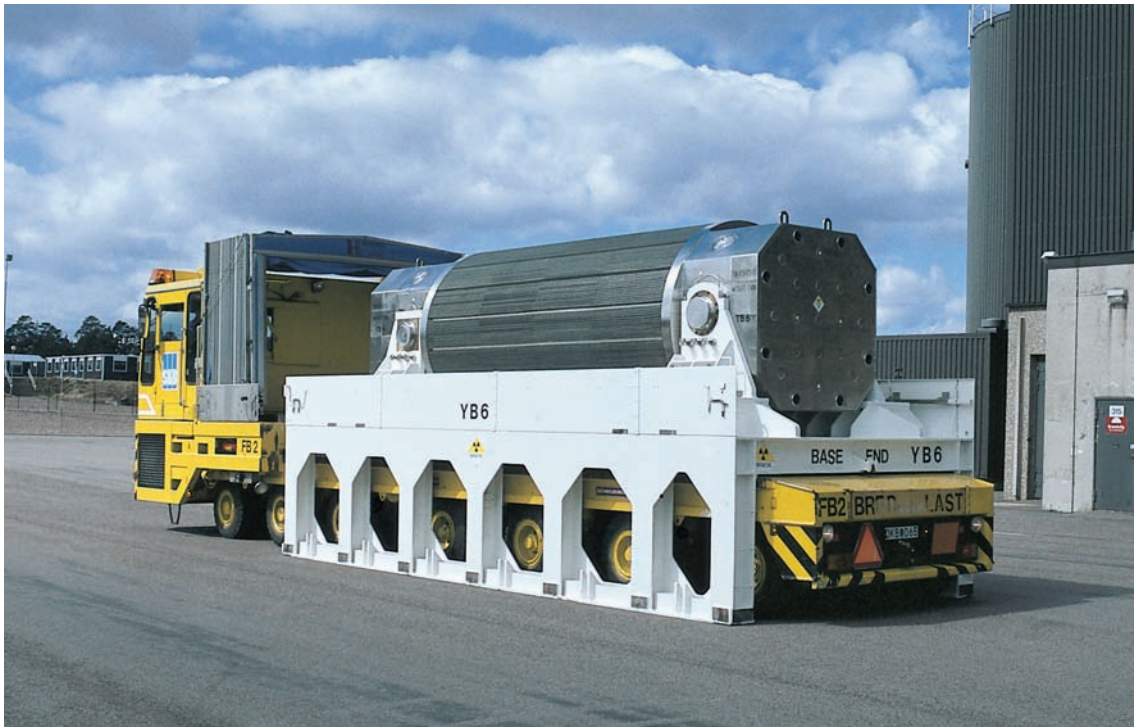
Figur 3-3. Terminalfordon med transportbehållare för använt kärnbränsle.
