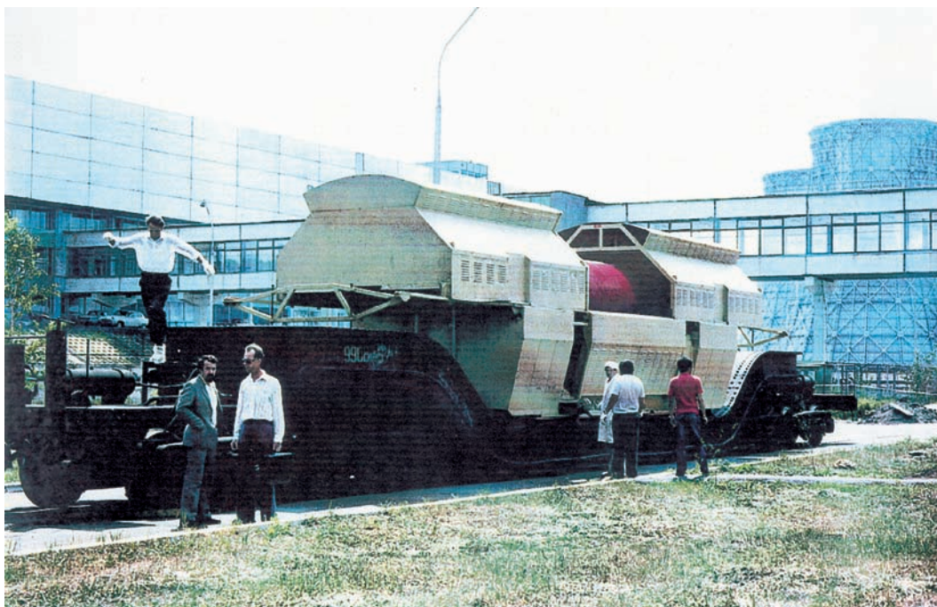
Figur 3-6. Transportbehållare på järnvägsvagn med vädskydd.
