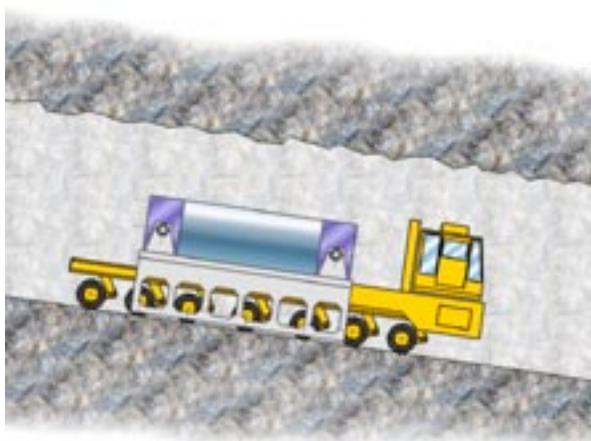
Figur 14-12. Rampfordon för transport av kapseln till undermarksanläggningen.
