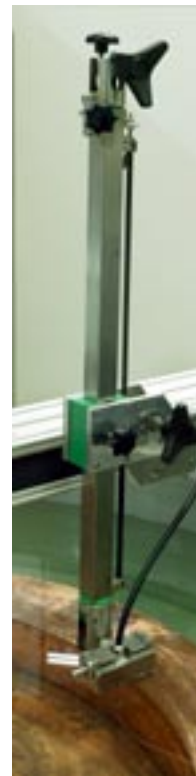
Figur 14-7. Rotationsbordet. Lock och botten sänks ner i en vattenfylld tank där de undersöks med ultraljud.
