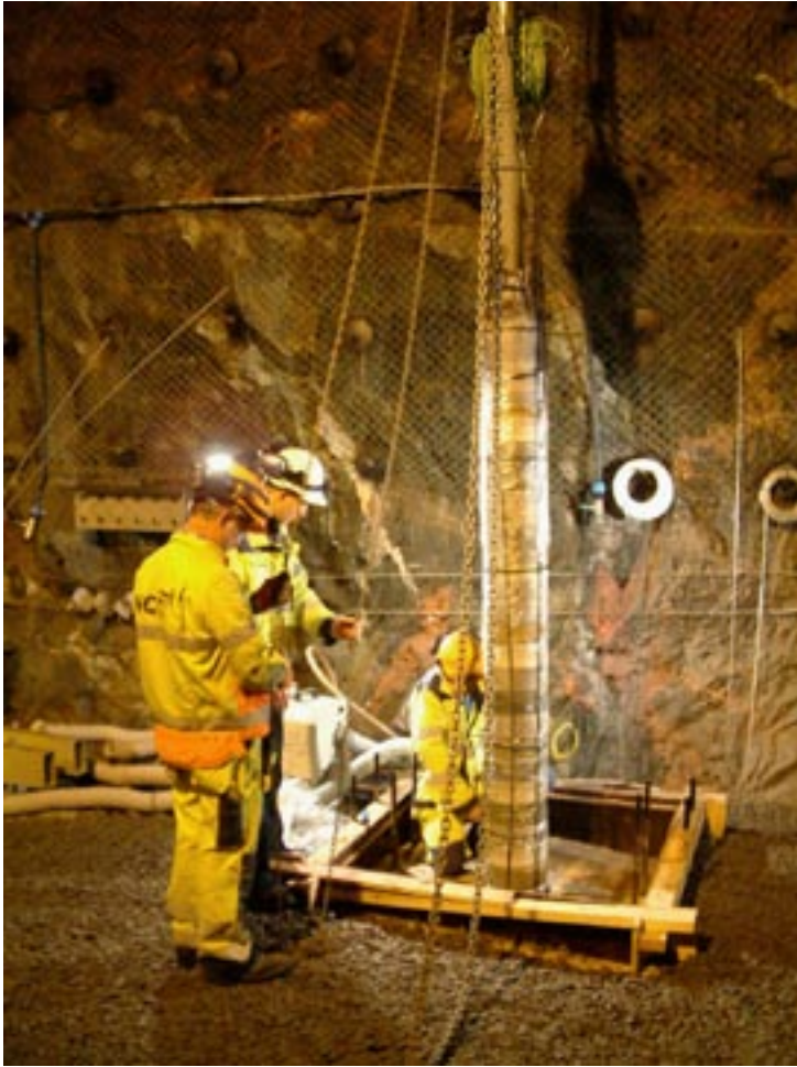
Figur 24-1. Installation av ett av paketen med 13 olika material i försöket "Alternativa buffertmaterial" i Äspölaboratoriet.
