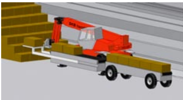
Figur 15-3. Utrustning för transport och installation av block.
