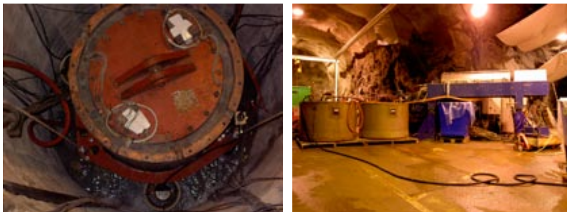
Figur 17-1. Demonstration av friläggningen av en kopparkapsel med den hydrodynamiska metoden i Äspölaboratoriet. Till vänster visas uppslammningen av bentonitbufferten och till höger visas utrustningen för avvattnings.
