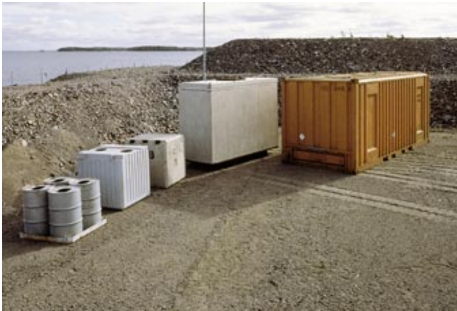
Figur 35-1. Avfallsbehållare för kortlivat avfall. Foto: Bengt O Nordin.
