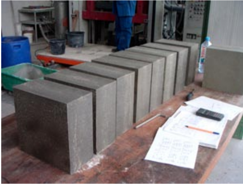
Figur 15-2. Några av de producerade återfyllningsblocken (300×300×160 millimeter).
