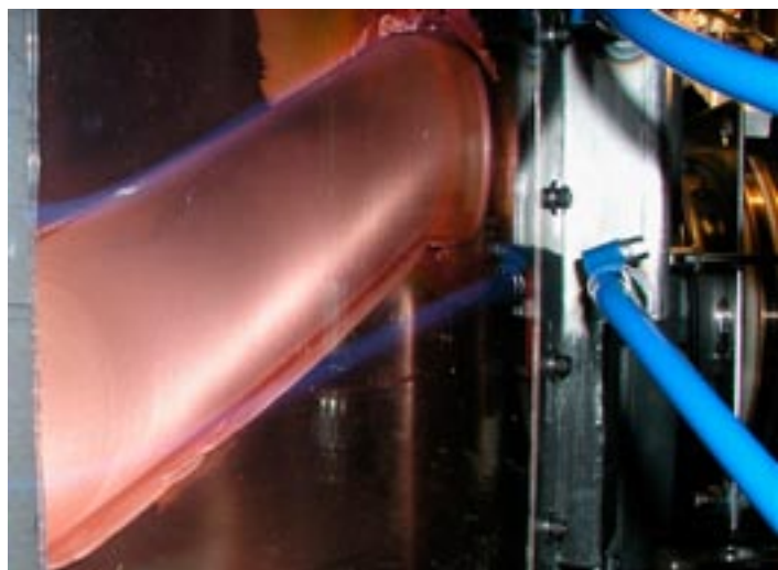
Figur 14-9. FSW med argongaskammare.
