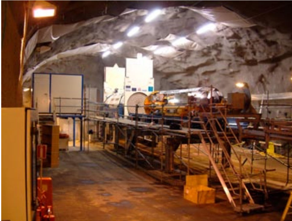
Figur 18-3. KBS-3H – deponeringsutrustning i Äspölaboratoriet på 220 meters djup.
