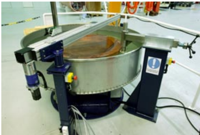
Figur 14-7. Rotationsbordet. Lock och botten sänks ner i en vattenfylld tank där de undersöks med ultraljud.
