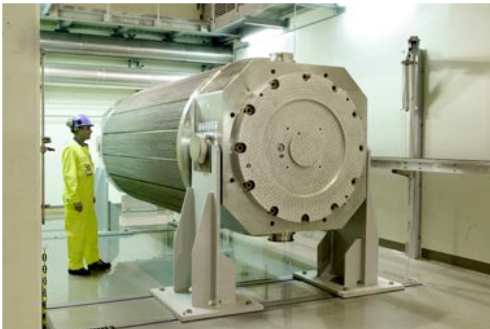
Figur 1-5. Transportbehållare för använt kärnbränsle.
