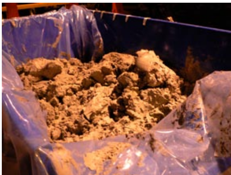
Figur 17-3. Avvattnad bentonit från dekantern.
