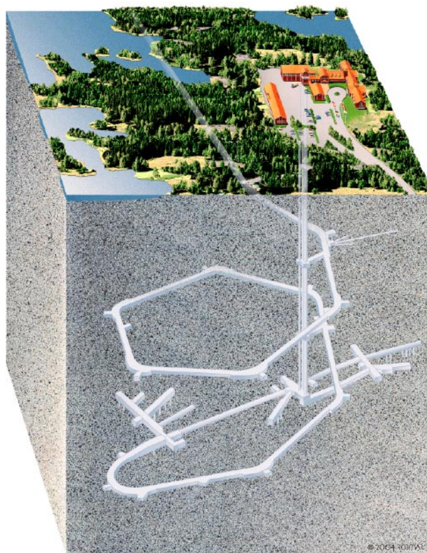
Figur 3-2. Principiell illustration av Äspölaboratoriet.
