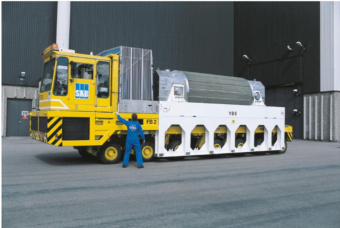
Figur 3-4. Terminalfordon med transportbehållare.
