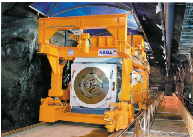
Figur 3-3. Demonstrationsanläggningen i Äspölaboratoriet med uppställd deponeringsmaskin.
