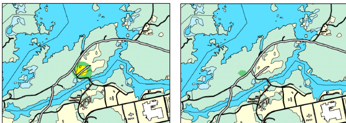
Figur 4-9. Jämförelse mellan ljudutbredning från hjullastare (tv) och berghiss i markplanet (th). Riktvärde 60 dBA – dagperioden (gräns mellan grönt och gult fält).
