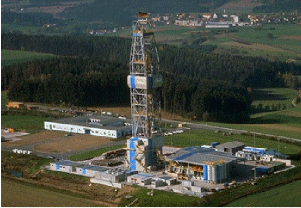
Figur 4-2. Borrigg – UTB-1 GH 300 EG - använd i det kontinentala djupborrningsprogrammet i Tyskland. /Harrison 2000/.
