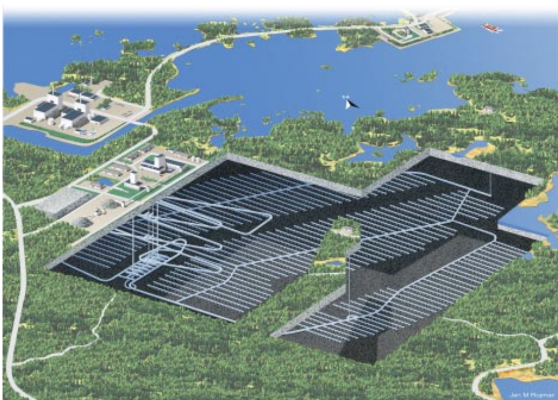
Figur 2-2. Slutförvarets preliminära placering i lokaliseringalternativet Forsmark.
