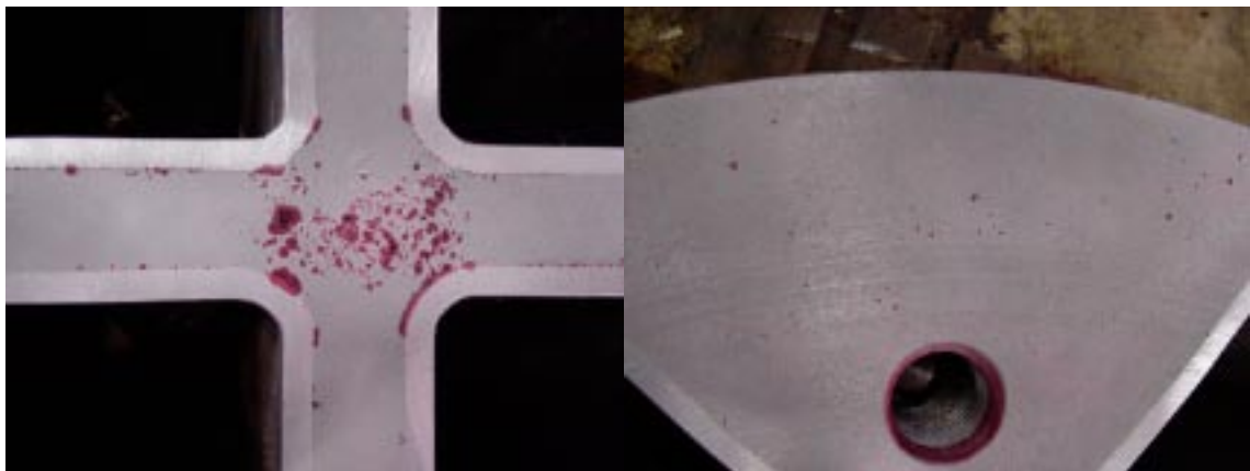
Figur 6-4. Penetrantprovning vid ett kapningsnitt för insats I26. Vänster bild visar på sugningsporer mellan kanalrören medan höger bild visar på indikationer i de yttre homogena delarna (dessa diskontinuiteter var dock relativt små).
