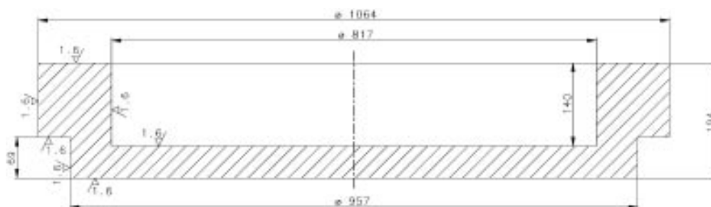
Figur 5-6. Figur över tänkt geometri för provning av lock/botten.
